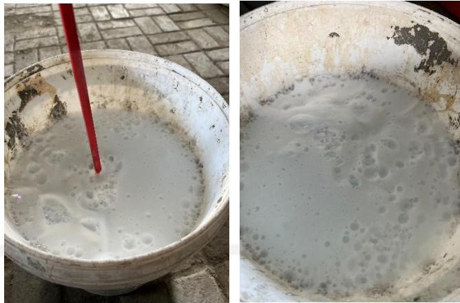
Gambar 4.2 Proses Pembuatan Foam Dan Hasilnya
