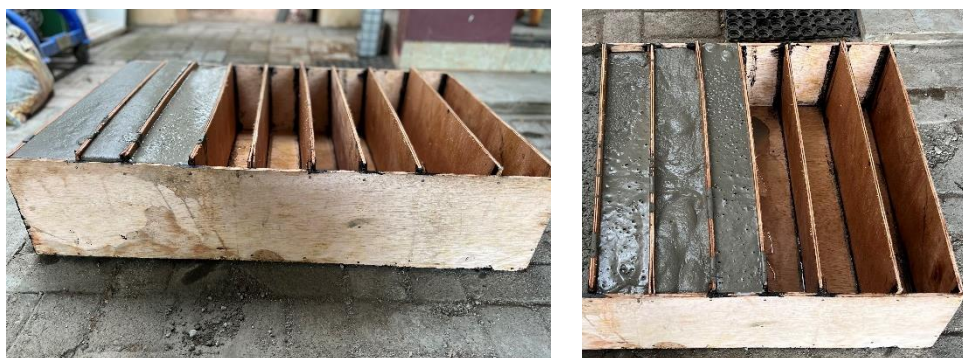
Gambar 4.4 Proses Pencetakan Bata Ringan CLC
