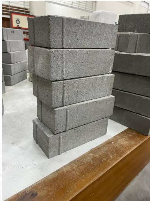
Gambar L-4.14 Benda Uji Kering Setelah Dioven
