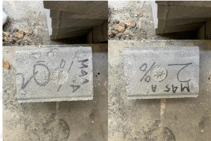
Gambar L-4.12 Setelah Pengujian Ketahanan Aus Variasi 20%
