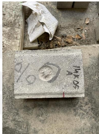
Gambar L-4.8 Setelah Pengujian Ketahanan Aus Variasi 0%
