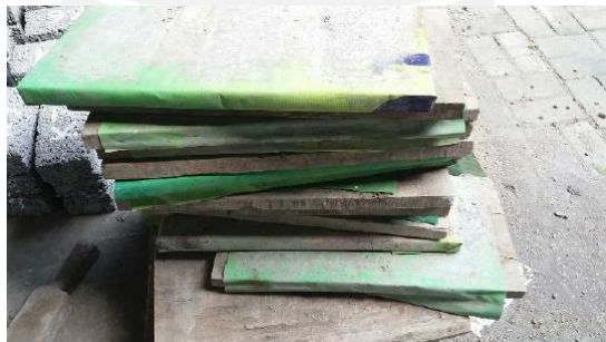
Gambar 4. 15 Papan Alas Cetak (Sumber: Dokumentasi Pribadi)
