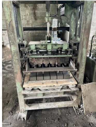
Gambar 4. 18 Pencetakan Benda Uji (Sumber: Dokumentasi Pribadi)
