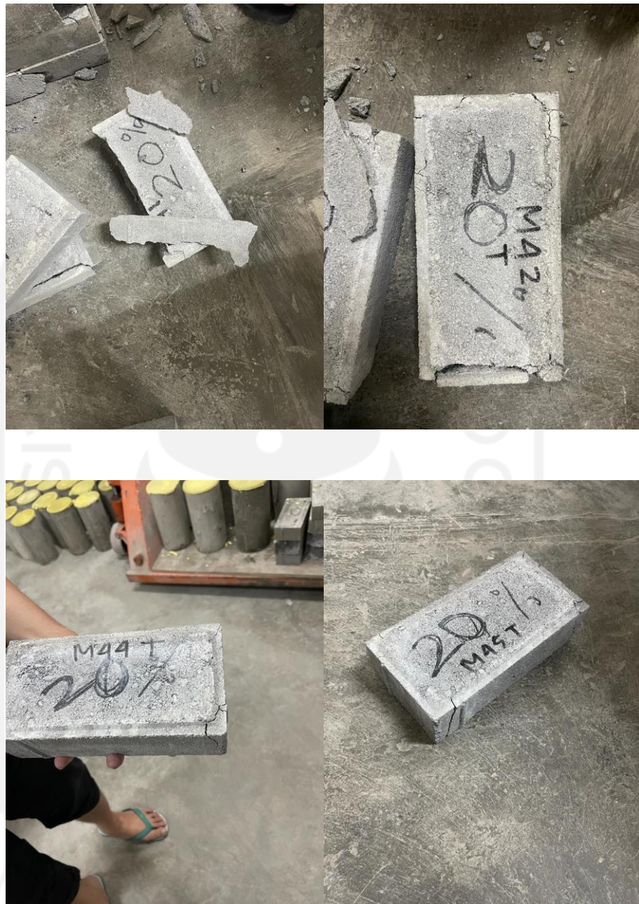
Gambar L-4.6 Setelah Pengujian Kuat Tekan Variasi 20%
