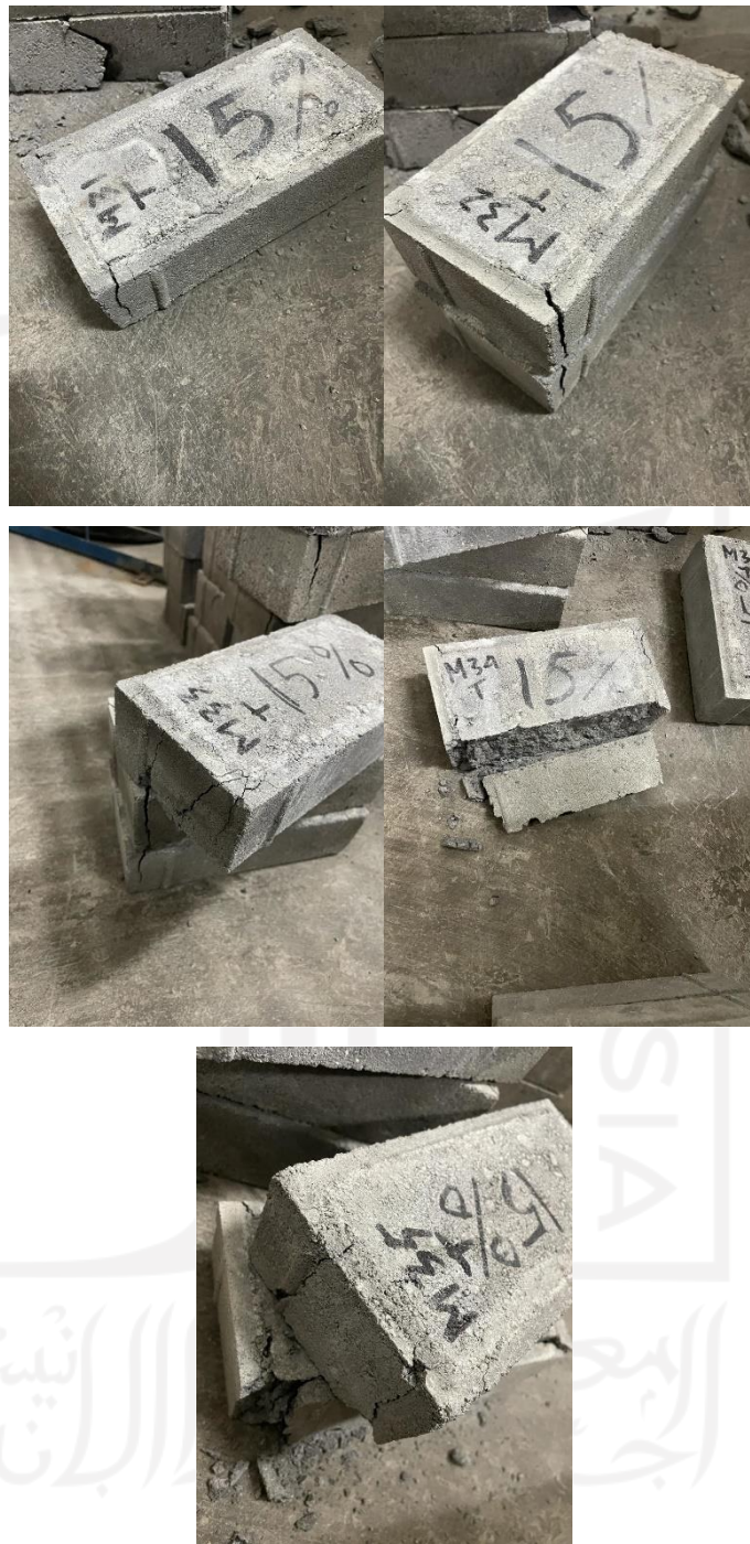
Gambar L-5.5 Setelah Pengujian Kuat Tekan Variasi 15%
