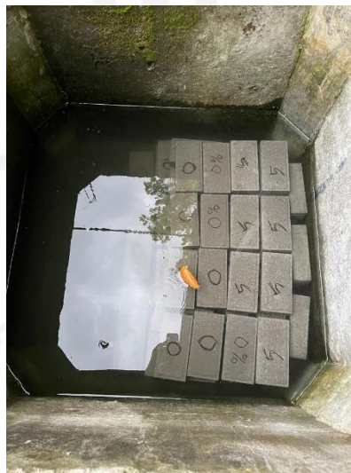
Gambar 4. 19 Perendaman Benda Uji (Sumber: Dokumentasi Pribadi)
