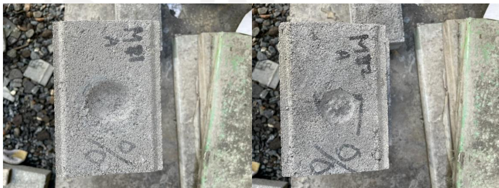
Gambar L-4.8 Setelah Pengujian Ketahanan Aus Variasi 0%
