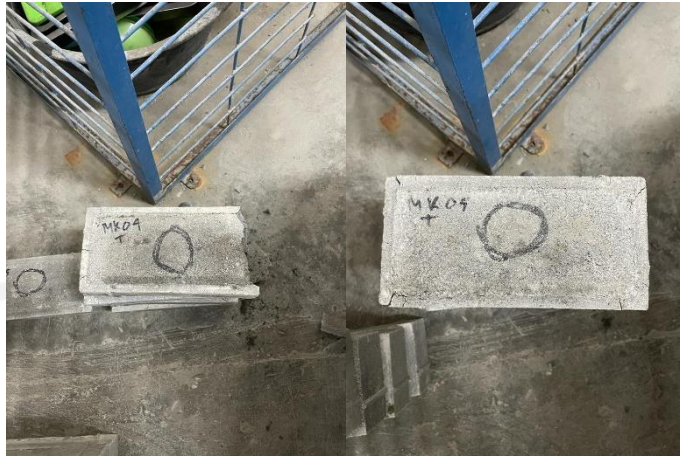
Gambar L-4.2 Setelah Pengujian Kuat Tekan Variasi 0%
