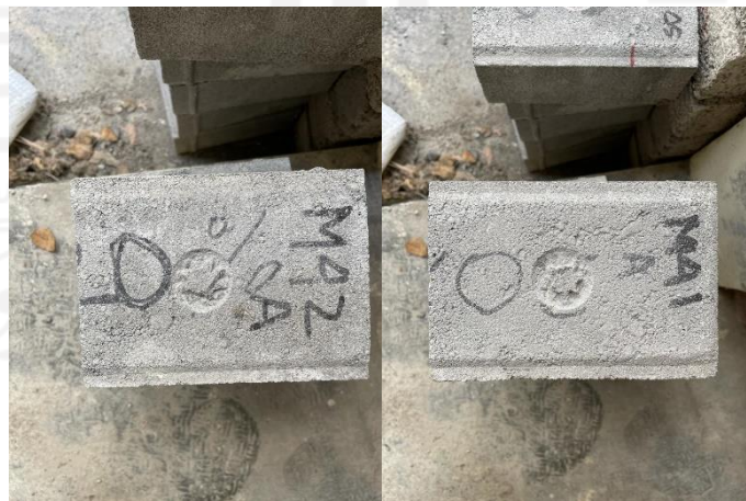
Gambar L-4.11 Setelah Pengujian Ketahanan Aus Variasi 15%
