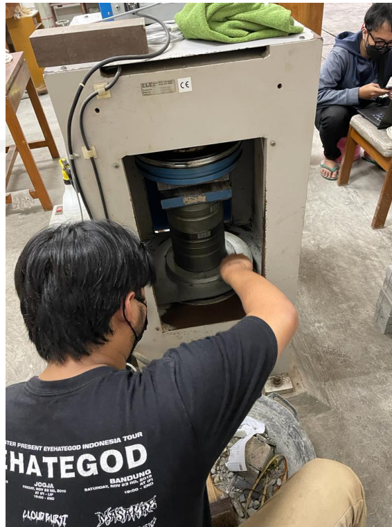
Gambar L-4.1 Pengujian Kuat Tekan
