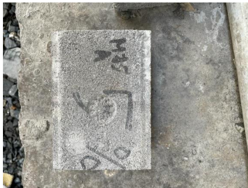
Gambar L-4.9 Setelah Pengujian Ketahanan Aus Variasi 5%
