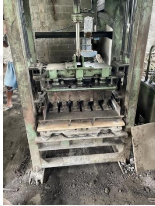
Gambar 4. 12 Cetakan paving block (Sumber: Dokumentasi Pribadi)
