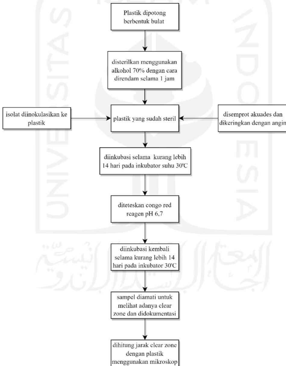
Gambar 3. 9 Bagan alir uji degradasi mikroplastik dengan Bakteri
