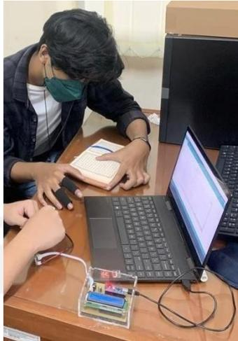
Dalam pengambilan data selama membaca Alquran, dipasangkan GSR yang sinyalnya akan direkam melalui software Arduino yang kemudian diterjemahkan menjadi output data.
