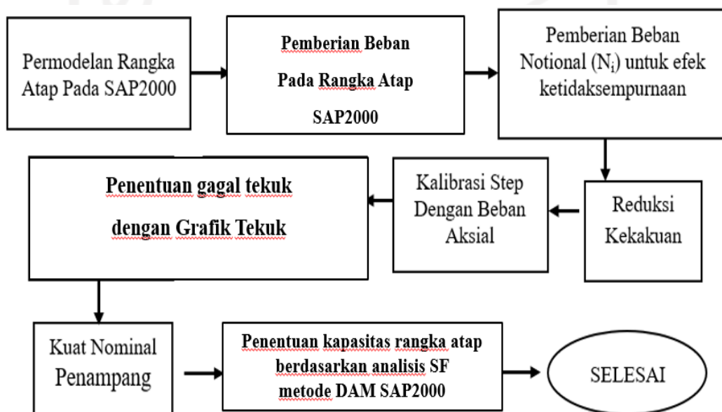
Gambar 4.17 Flowchart Pemodelan Rangka Atap Pada SAP2000
