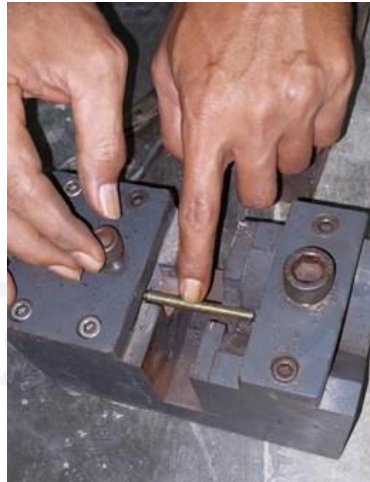
Gambar 4.7 Set Up Pengujian Kuat Geser Baut Tampak Atas
