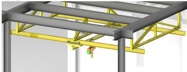
Gambar 3- 9 Konsep rancangan dengan konfigurasi trolley di bawah girder Pertimbangan desain trolley di bawah:
