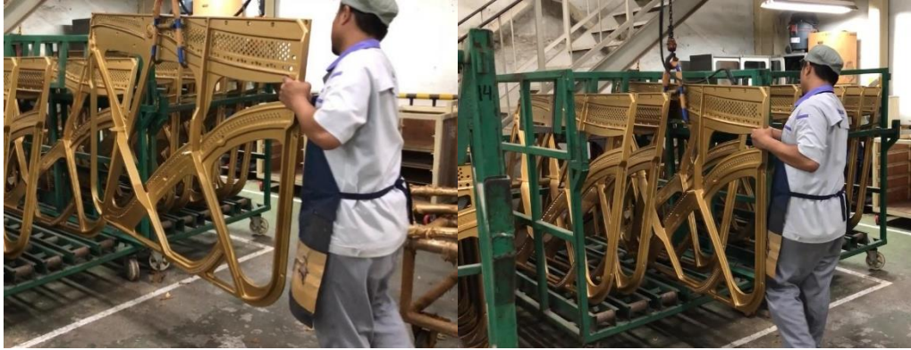
Gambar 4- 18 Proses mengangkat frame pada bagian frame delivery
