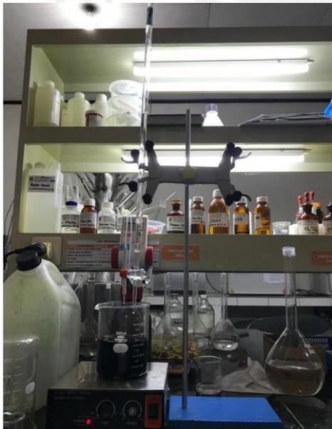
Standardisasi Larutan  $\text{Na}_2\text{S}_2\text{O}_3$
