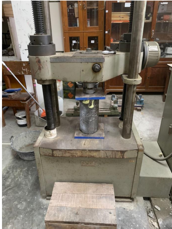
Gambar L-4.3 Proses Pengujian Kuat Tekan
