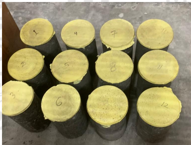
Gambar L-4.2 Proses Persiapan Pengujian Kuat Tekan
