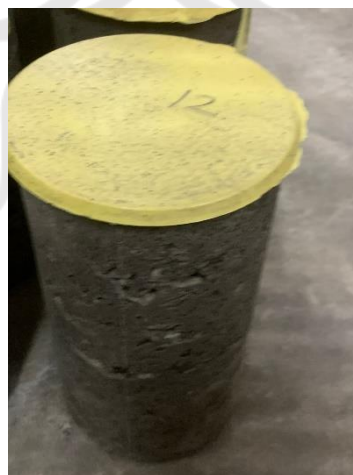
Gambar 5.3 Contoh Benda Uji Pengujian Kuat Tekan
