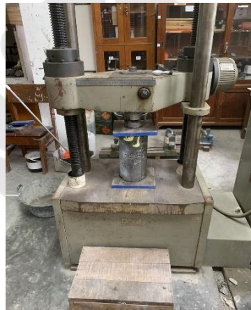
Gambar 5.2 Pengujian Kuat Tekan
