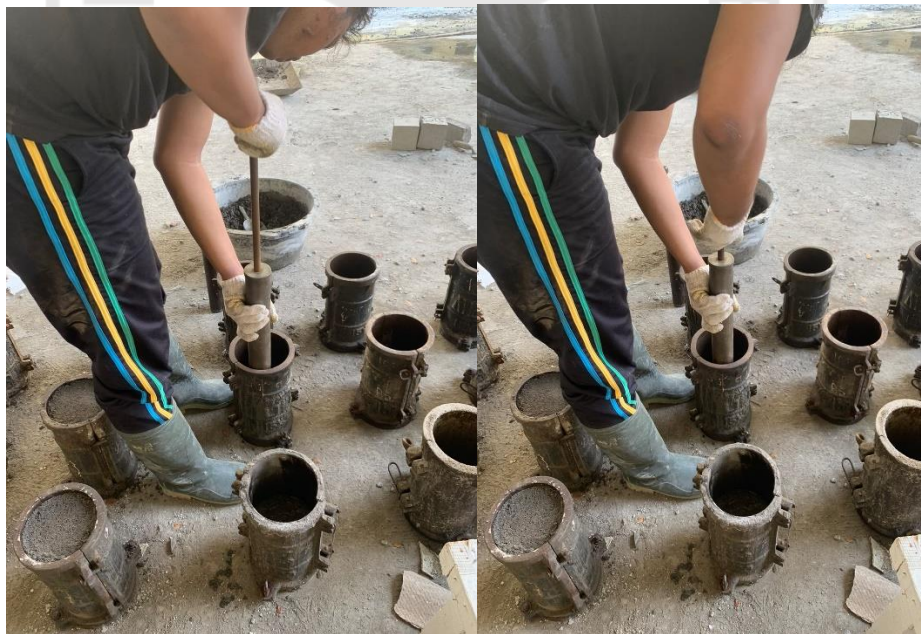
Gambar L-3.5 Proses Pemadatan Campuran CTB dalam Cetakan
