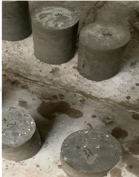
Gambar L-3.6 Proses Pelepasan CTB dari Cetakan Silinder
