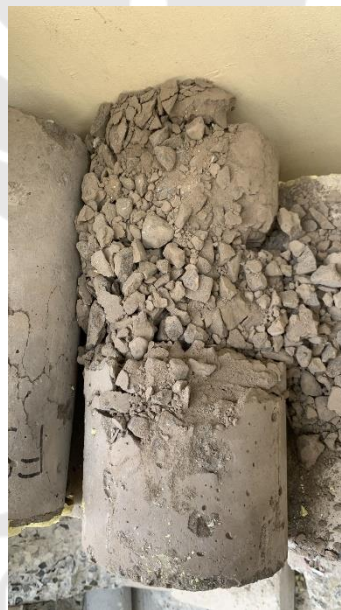
Gambar L-4.4 Hasil Proses Pengujian Kuat Tekan
