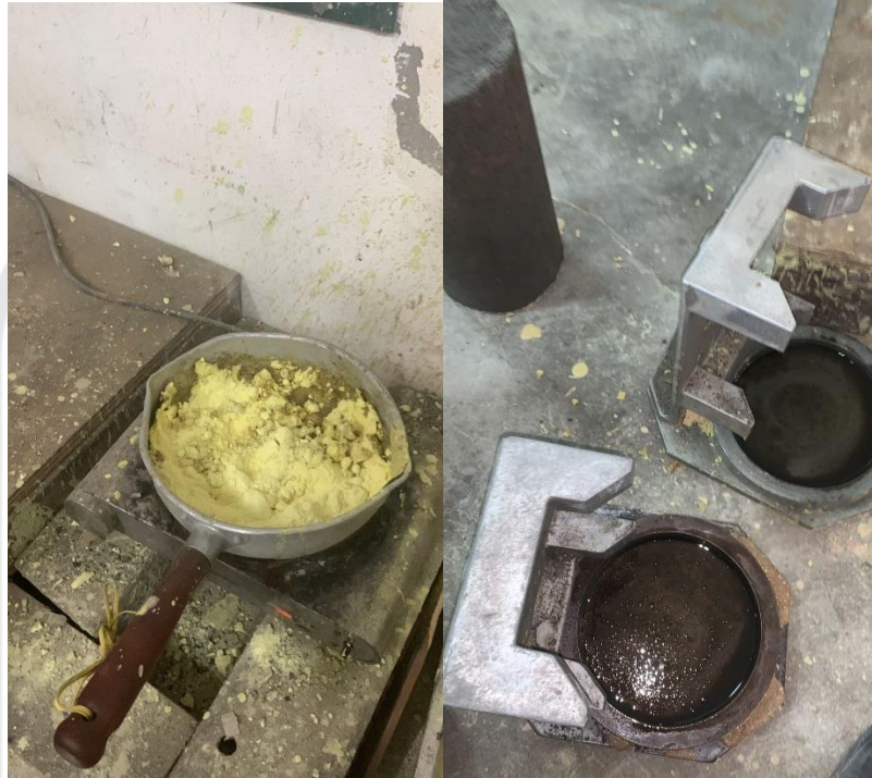
Gambar L-4.1 Proses Kaping Benda Uji
