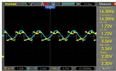
gambar 1.5 Gelombang Keluaran Sinyal Six-Step H1 Terhadap Gelombang Back EMF
