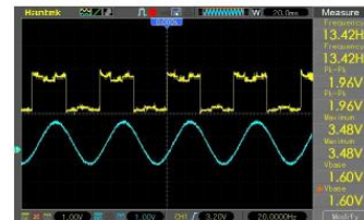
gambar 1.7 Gelombang Keluaran Sinyal Six-Step H3 Terhadap Gelombang Back EMF
