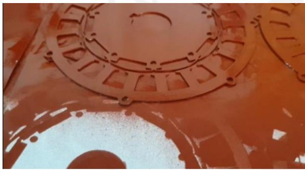
Laminasi pada stator dan rotor.
