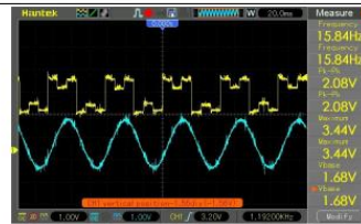
gambar 1.6 Gelombang Keluaran Sinyal Six-Step H2 Terhadap Gelombang Back EMF
