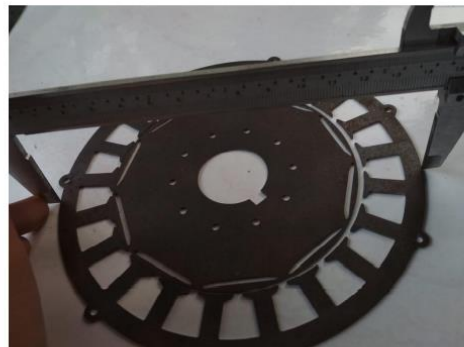
Gambar 8. Pengukuran Sampel Plat Setelah proses Pematangan
