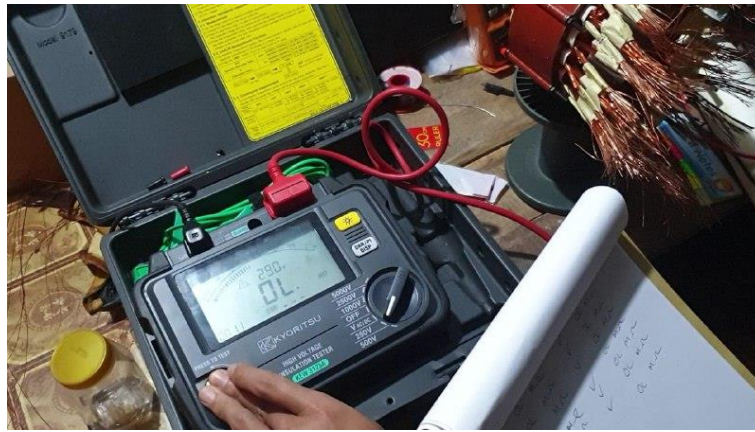
Gambar 5.3 Pengukuran isolasi kumparan
