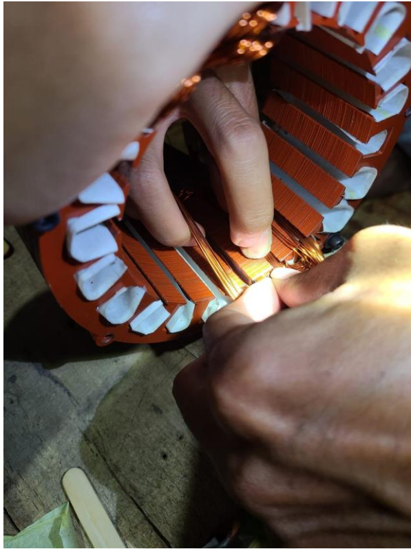
Pemasangan kumparan pada stator.
