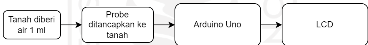
Gambar 3.2 Diagram blok sistem alat pendeteksi tingkat kesuburan tanah
