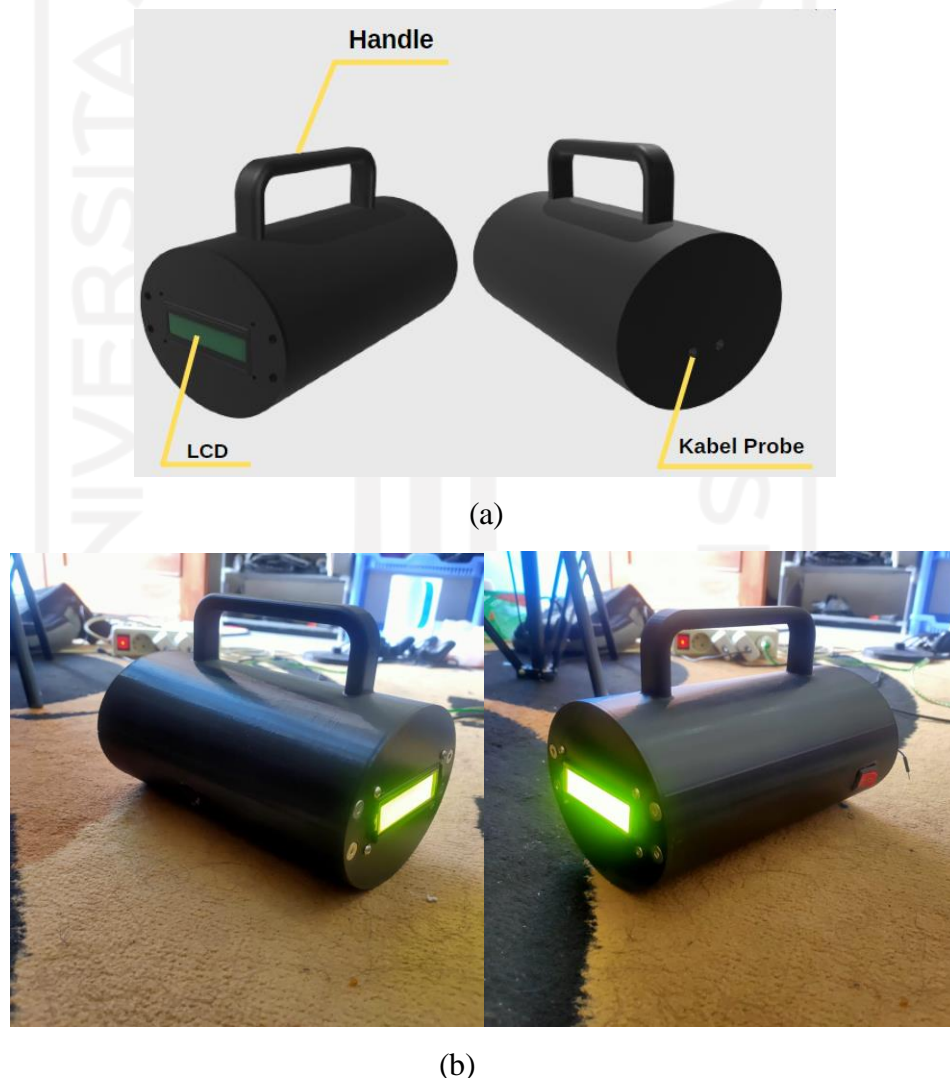
Gambar 4.1 Perbandingan desain 3D (a) dengan hasil realisasinya (b)
