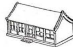
Gb.4. Atap model Ngang Shan. Atap model ini yang sering dipakai di daerah Pecinan Indonesia.
