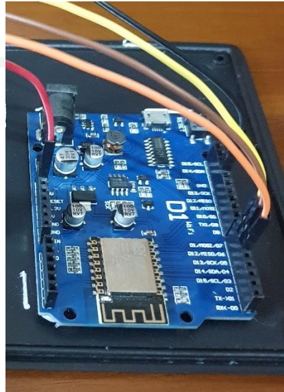
Gambar 3.17 Pin wemos ke relay
