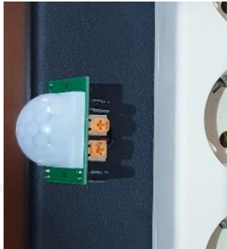
Gambar 3.18 Konfigurasi sensor PIR
