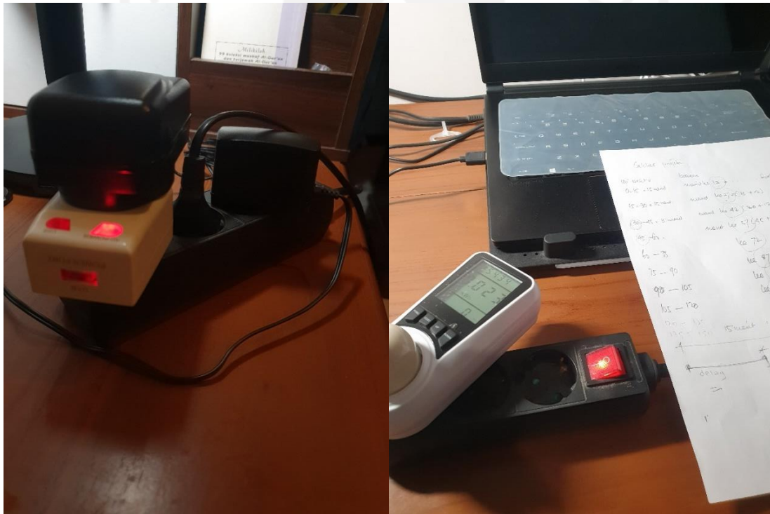
b. Gambar kanan pengujian daya menggunakan alat multi meter dan gambar kiri kondisi pengujian daya stop kontak konvensional
