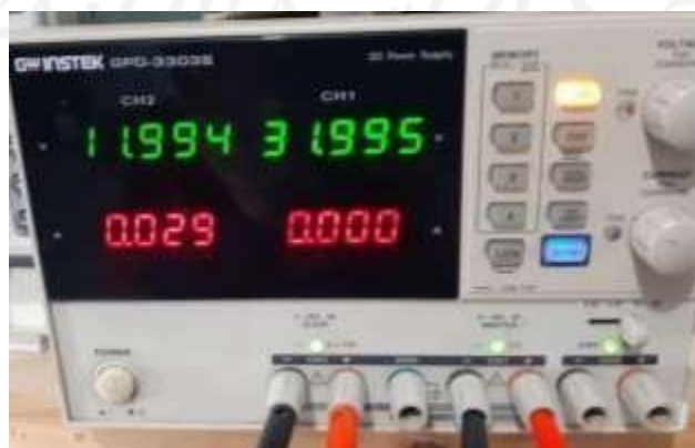
Gambar 5. 4 Konsumsi arus pada rangkaian bootstrap dan beban
