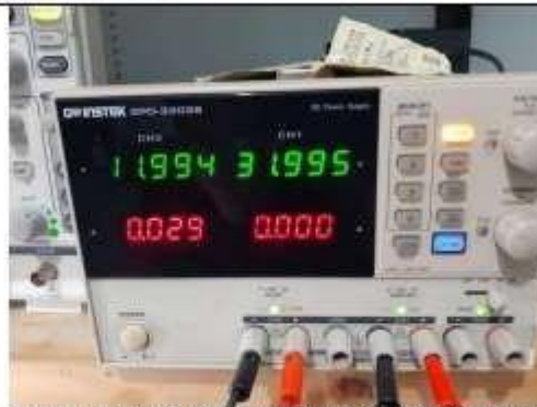
Gambar 4. Supply tegangan Bootstrap dan tegangan utama rangkaian half bridge
