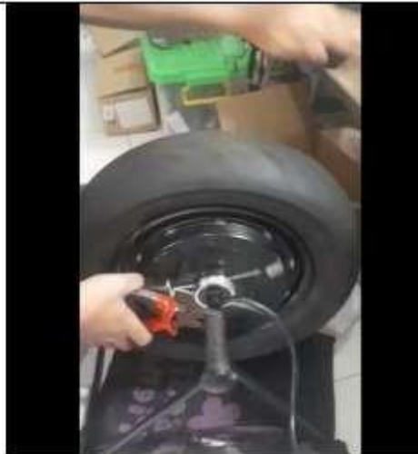
gambar 5. pemutaran motor secara manual dengan tangan
