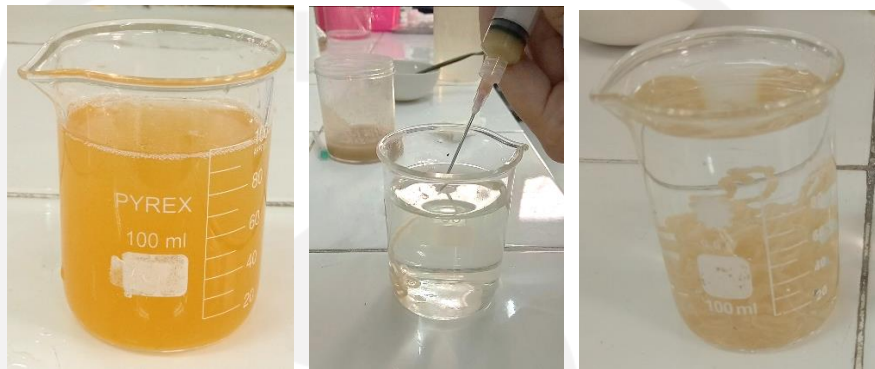
Preparasi larutan Na-alginat, proses enkapsulasi, dan pencucian dengan aquades
