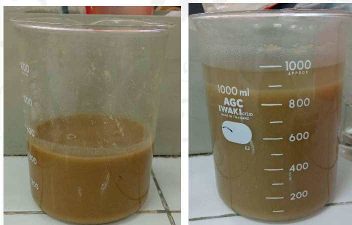
Ampas Tebu berukuran 70 mesh diaktivasi dan dibilas hingga pH netral
