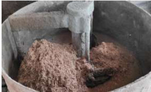
Gambar 4.23 Proses Pencampuran Kulit Jagung, Sekam Padi, dan Abu Batu
