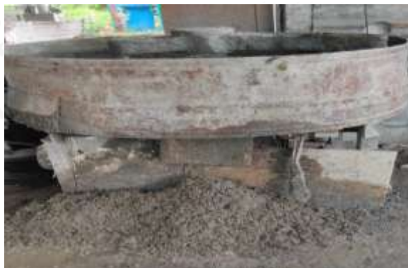
Gambar 4.27 Proses Penuangan Campuran Batako dari Mesin Pengaduk
