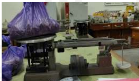
Gambar 4.20 Proses Penimbangan Bahan Penyusun Batako
