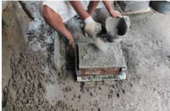
Gambar 4.30 Proses Penambahan Semen Portland dan Pasir Dengan Perbandingan 1 : 1
