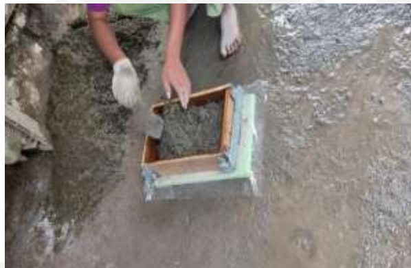
Gambar 4.29 Proses Pemadatan Dalam Pencetakan Batako Secara Manual
