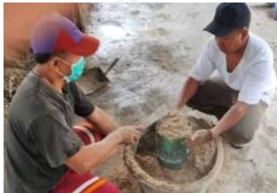
Gambar 4.21 Proses Penakana Serat Kulit Jagung
