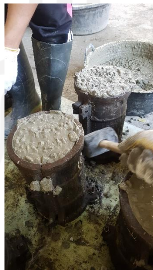
Gambar L-3.6 Proses Pencetakan dan Pematatan
