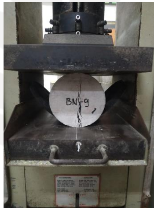
Gambar L-3.11 Proses Pengujian Kuat Tarik Belah Beton
