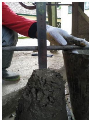
Gambar L-3.5 Pengujian Nilai Slump
