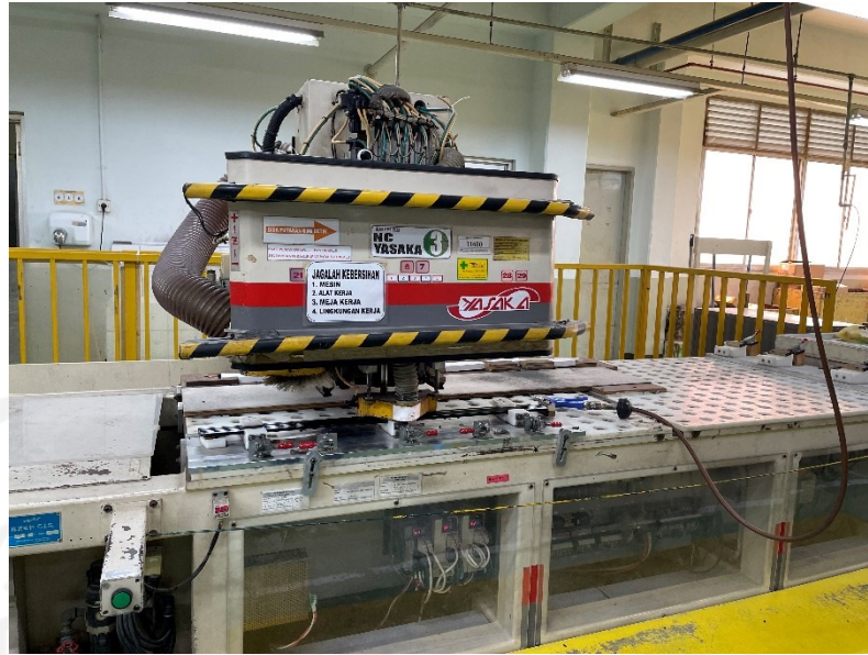
Gambar 3-7 Proses pelubangan hinge menggunakan mesin NC
