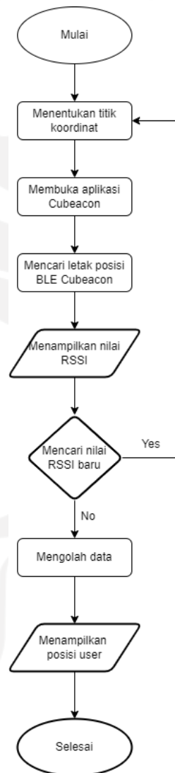
Gambar 3.2. Proses cara kerja sistem
