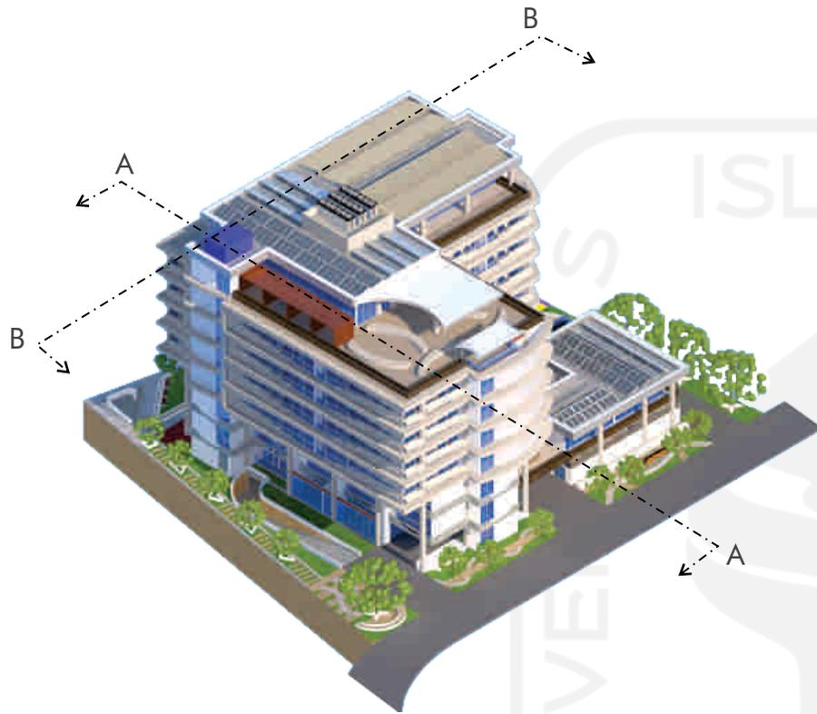
Sampel pengujian berupa model potongan ini diambil pada pukul 09.00, sinar matahari yang masuk ke dalam ruang dari yang terkecil 63 lux sampai yang terbesar 438 lux sisi sebelah timur. Terlihat pada potongan B - B sisi sebelah timur lebih banyak menerima sinar matahari yang masuk ke dalam ruangan dengan besaran 250 - 438 lux
