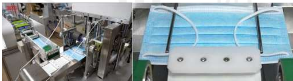
Gambar 3.13 Proses Pemasangan Tali Masker dengan (a) Pemasangan Tali Masker (b) Pengujian Tali Masker[21]
