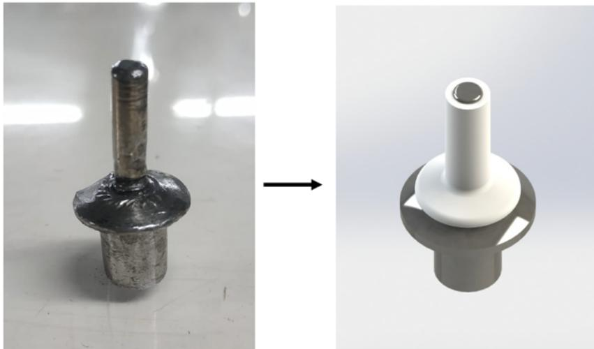
Gambar 5.1 Usulan Perbaikan Pin Winding Manual
