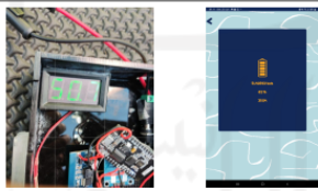
Gambar 4.2 Sisa baterai awal pada voltmeter (a) dan pada aplikasi EMOT (b) rute kecupat. Hasil pengujian yang ditunjukkan dengan Gambar 4.2 terdapat perbedaan pembacaan antara voltmeter dengan aplikasi, oleh sebab itu didapatkan persentase kesalahan pembacaan sebagai berikut.
