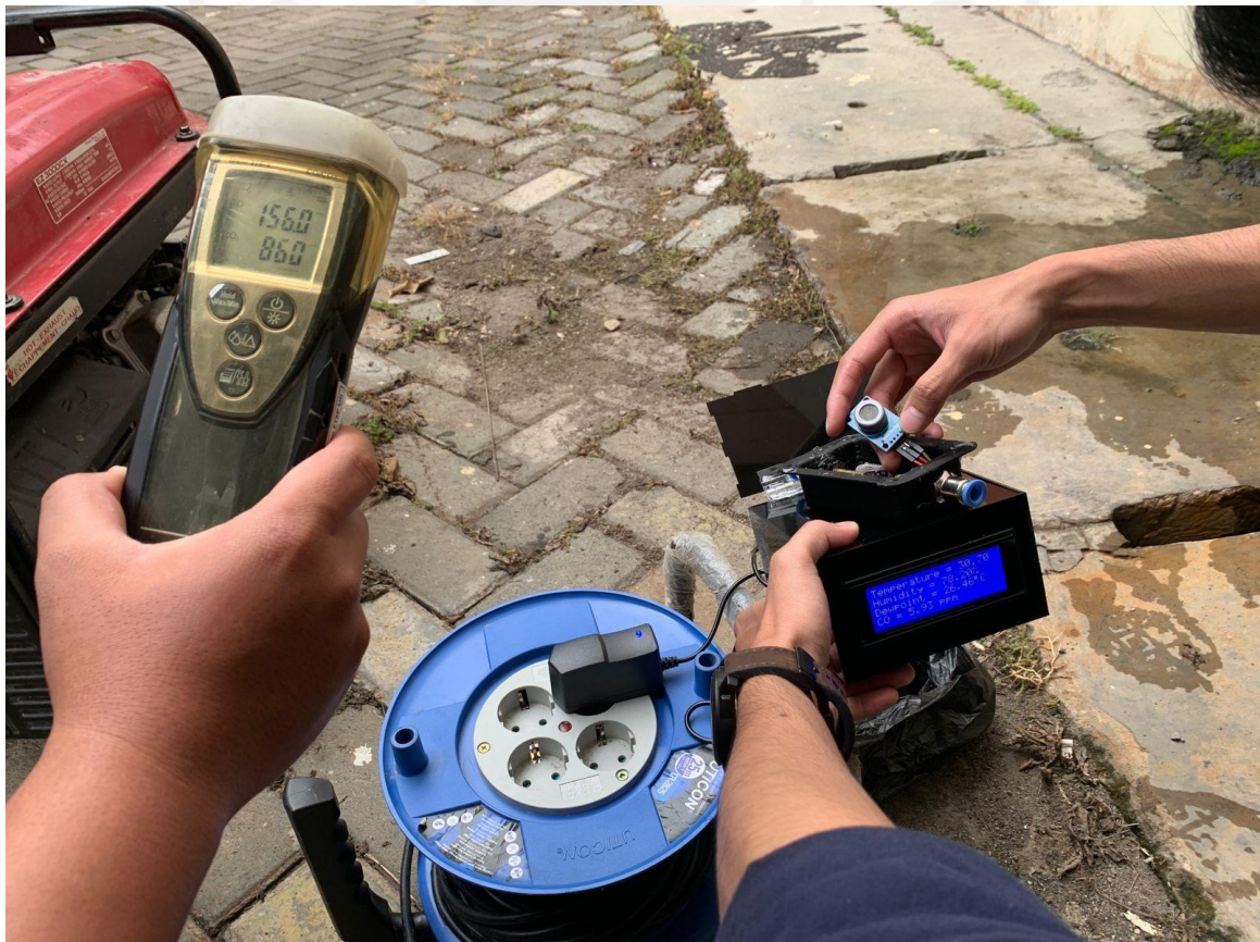
Gambar 7. Proses kalibrasi sensor MQ-7 dengan Carbon Monoxide Meter Testo 315-3
