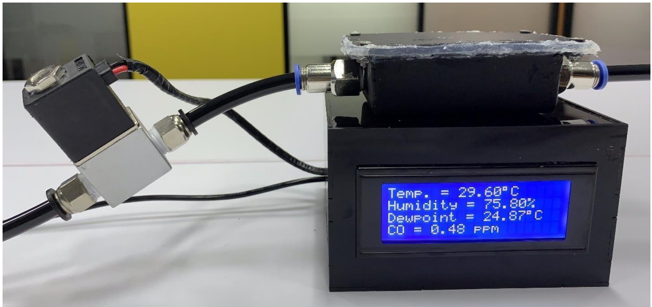
Gambar 4.7 Hasil realisasi alat tampak depan
