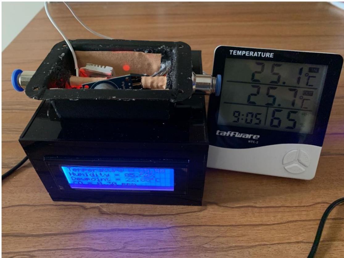
Gambar 8. Proses kalibrasi sensor DHT-22 dengan HTC-2
