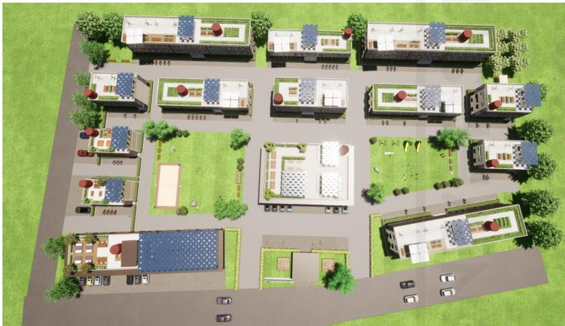
Pembayangan cahaya matahari pada kawasan co-housing pada jam 12.00 memperlihatkan pembayangan pada arah depan bangunan. Pembayangan diperlihatkan secara tegak lurus ke arah cahaya matahari. Sehingga ruang pada area menghadap fasad terpapar radiasi matahari. Pemberian shading pada area depan fasad bangunan menjadi solusi dari desain permasalahan ini.
