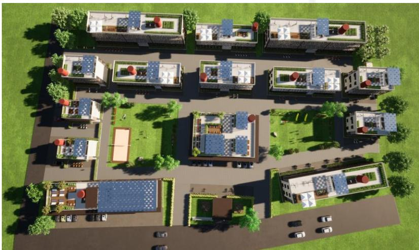
Pembayangan cahaya matahari pada kawasan co-housing pada jam 16.00 memperlihatkan pembayangan ke arah barat bangunan. Pembayangan memperlihatkan fasad bangunan terpanjang tidak terpapar matahari langsung.
