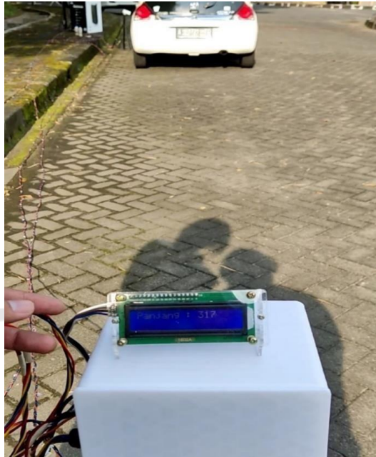
Gambar 5.4 Proses dari pengukuran panjang kendaraan dengan alat yang dibangun
