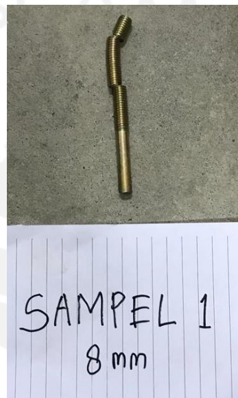
Gambar 5. 6 Kondisi Baut Sampel 1 Setelah Pengujian
