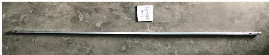
Gambar 5. 12 Sampel 1 Baut 1 Setelah Uji Tekan
