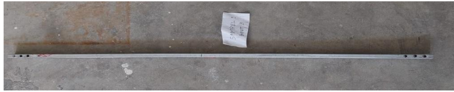
Gambar 5. 18 Sampel 1 Variasi Baut 3 Setelah Uji Tekan
