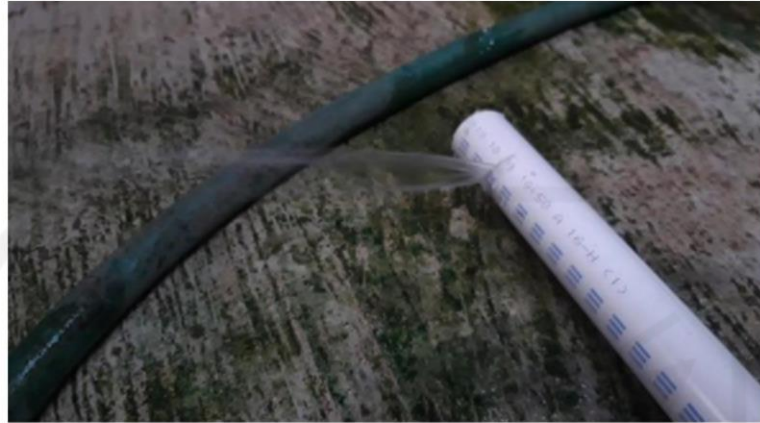
Gambar 4- 17 Foto uji pipa air bocor
