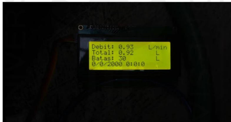
Gambar 4- 18 Pembacaan pipa air bocor
