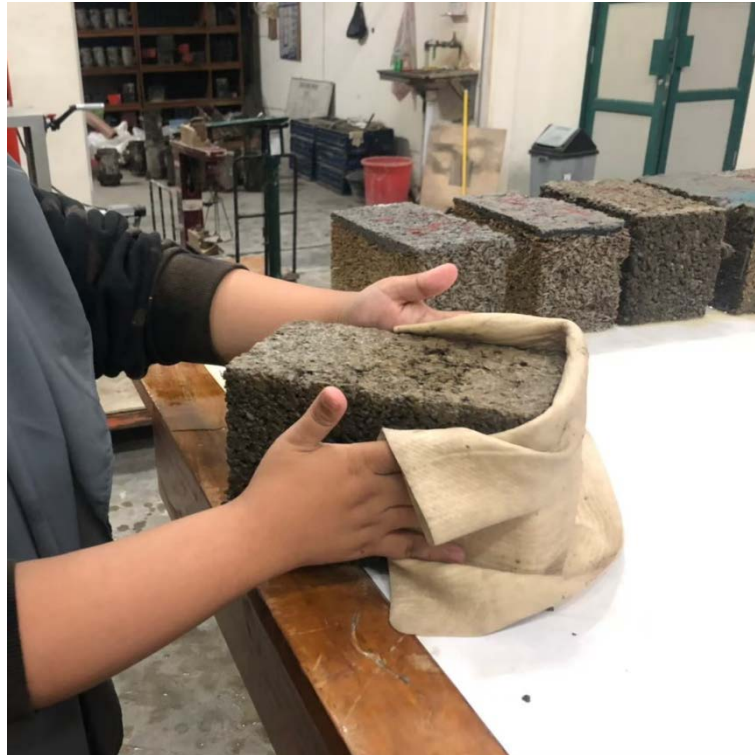
Gambar 4.15 Pengelapan Permukaan Batako
