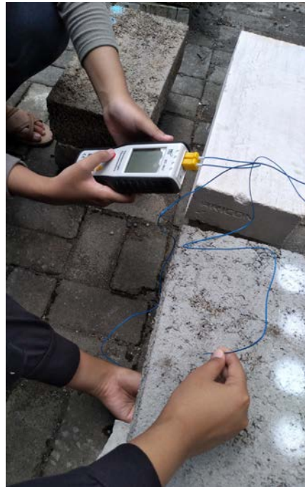
Gambar L 4.2 Pengukuran Suhu T1 dan T2 menggunakan Thermocouple
