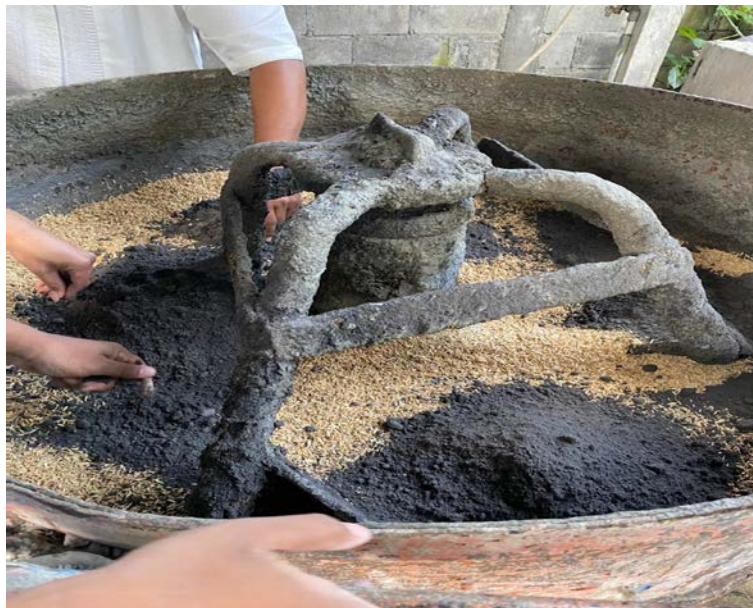
Gambar 4.6 Pencampuran Bahan dengan Alat Mixer Machine
