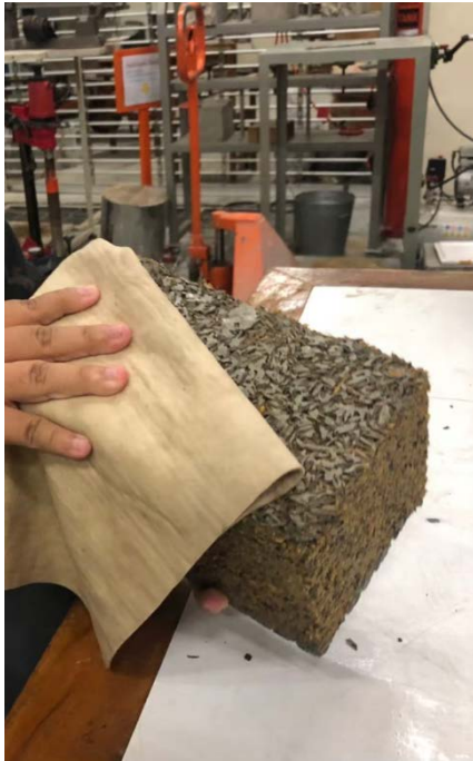
Gambar L 3.5 Menyeka Permukaan Batako
