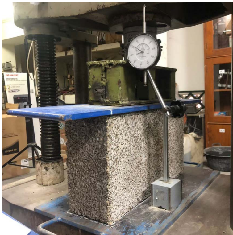
Gambar 4.13 Batako Diletakkan pada Alat Desak
