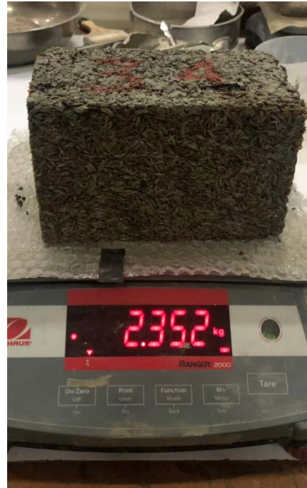
Gambar L 3.6 Penimbangan Benda Uji Kondisi Basah
