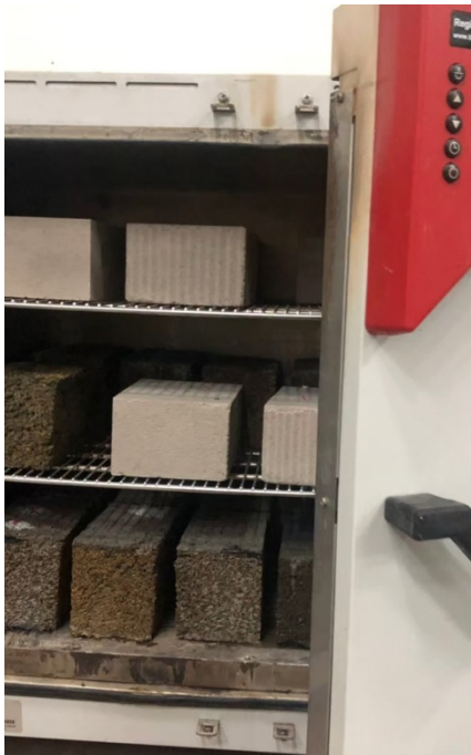
Gambar L 3.7 Pengeringan Benda Uji dengan Oven
