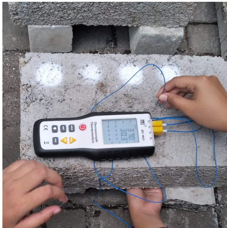
Gambar 4.17 Peletakan Kabel Thermocouple
