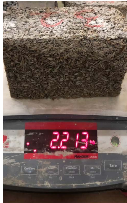
Gambar L 3.8 Penimbangan Benda Uji Kondisi Kering
