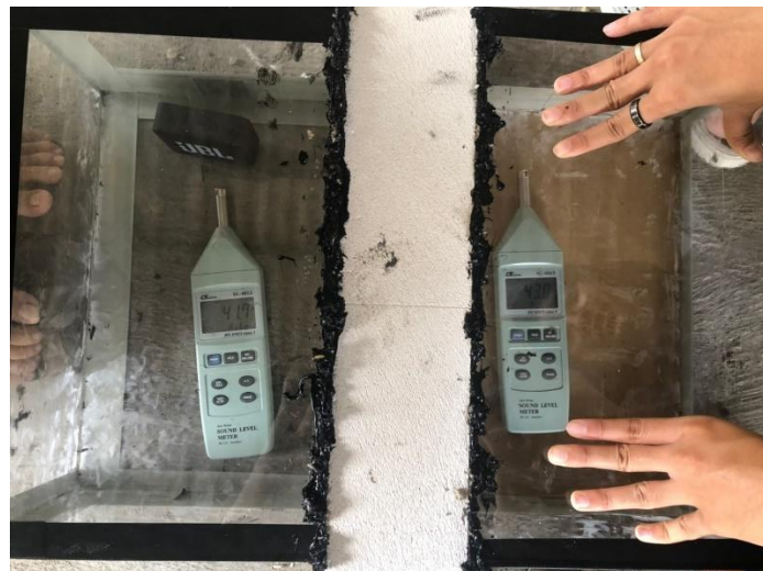
Gambar L-5.2 Pengujian Redaman Suara Bata Ringan Focon
