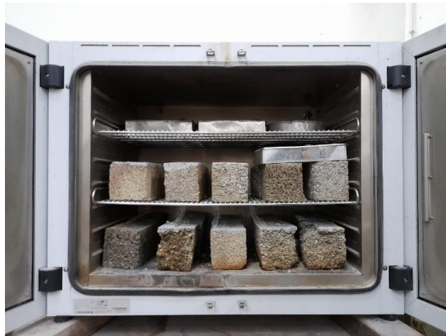
Gambar L-4.6 Benda Uji dimasukkan dalam Oven
