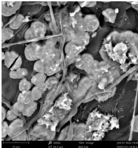
Gambar 5.11 Hasil Uji SEM Batako Bonggol Jagung Komposisi Campuran Bonggol Jagung 900%
