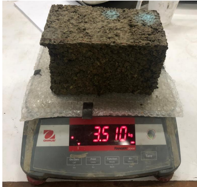
Gambar 4.7 Penimbangan Benda Uji
