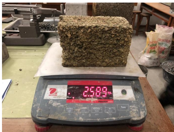
Gambar L-4.7 Penimbangan Benda Uji Setelah Oven
