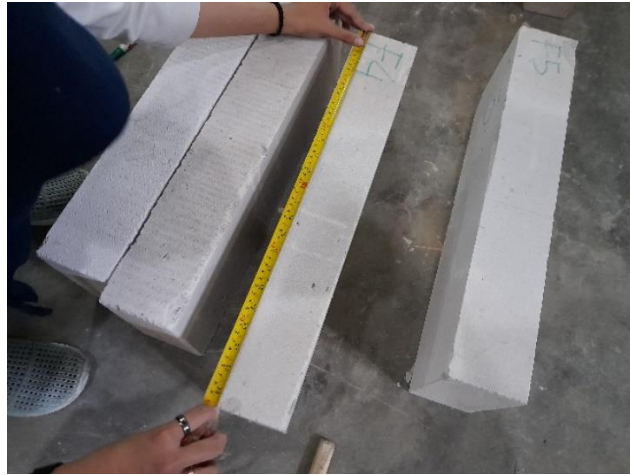
Gambar L-3.5 Pengukuran Bata Ringan Focon
