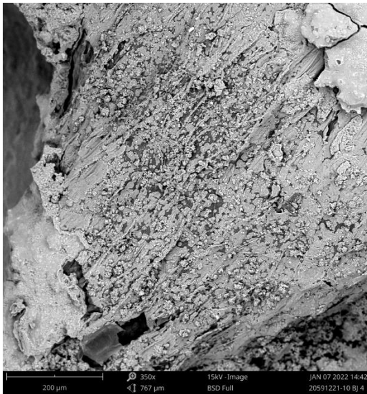
Gambar L-6.4 Pengujian SEM Batako Bonggol Jagung Komposisi Campuran Bonggol Jagung 900% Perbesaran 350x
