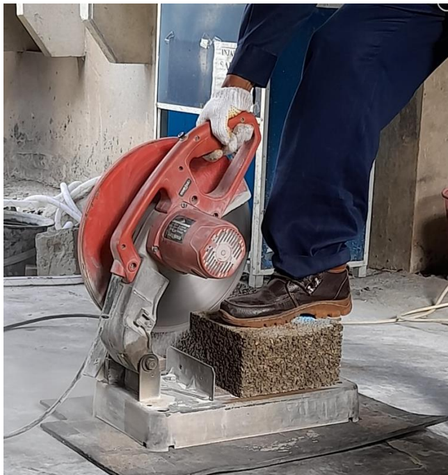
Gambar 4.6 Pemotongan Benda Uji Menjadi 4 Bagian
