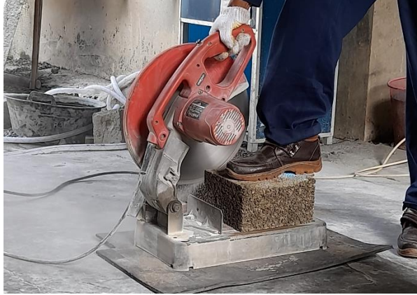
Gambar L-4.1 Pemotongan Batako Bonggol Jagung
