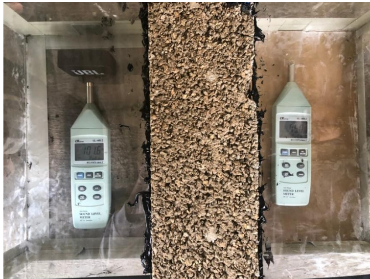
Gambar 4.10 Pengujian Redaman Suara
