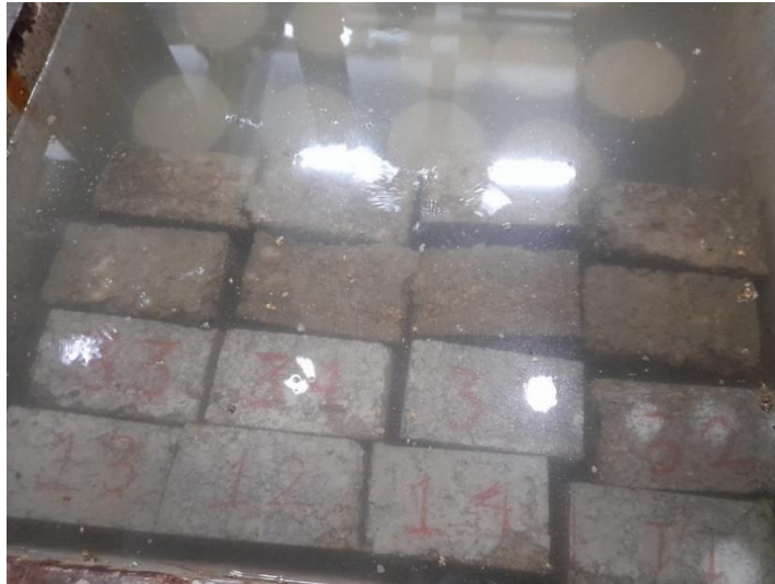
Gambar 4.8 Perendaman Benda Uji
