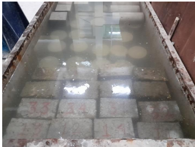
Gambar L-4.4 Perendaman Benda Uji
