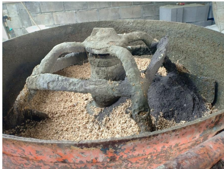
Gambar 4.2 Pencampuran Bahan Susun Batako
