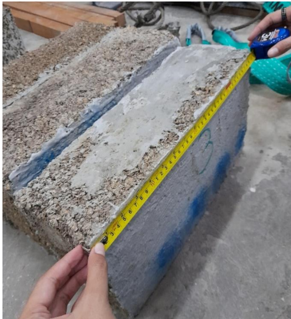
Gambar L-3.4 Pengukuran Batako Bonggol Jagung
