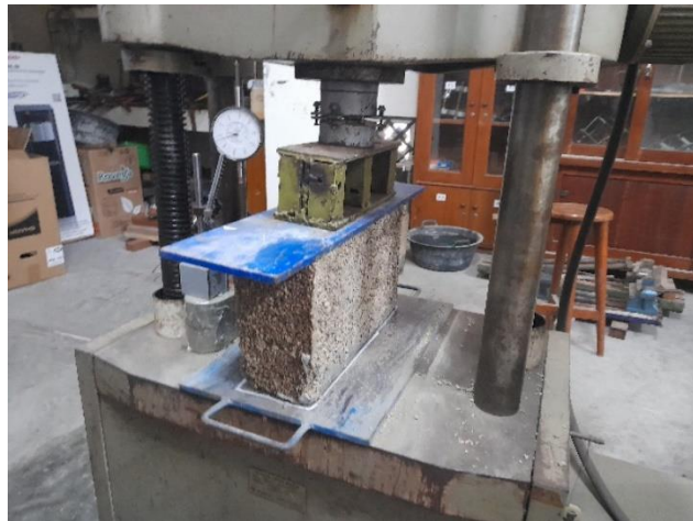
Gambar L-3.6 Uji Kuat Desak Batako Bonggol Jagung
