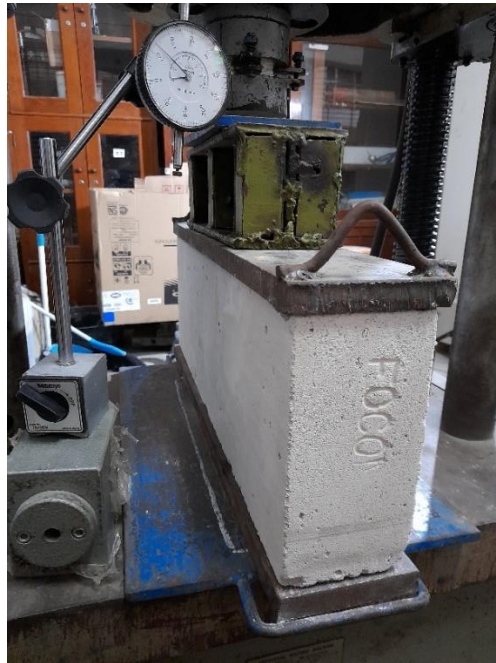
Gambar L-3.7 Uji Kuat Desak Bata Ringan Focon
