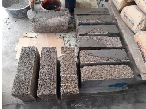
Gambar L-3.1 Perataan Permukaan Benda Uji Sebelum Uji Kuat Desak
