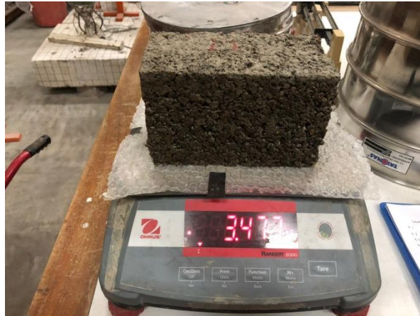
Gambar L-4.5 Penimbangan Benda Uji Sebelum Oven
