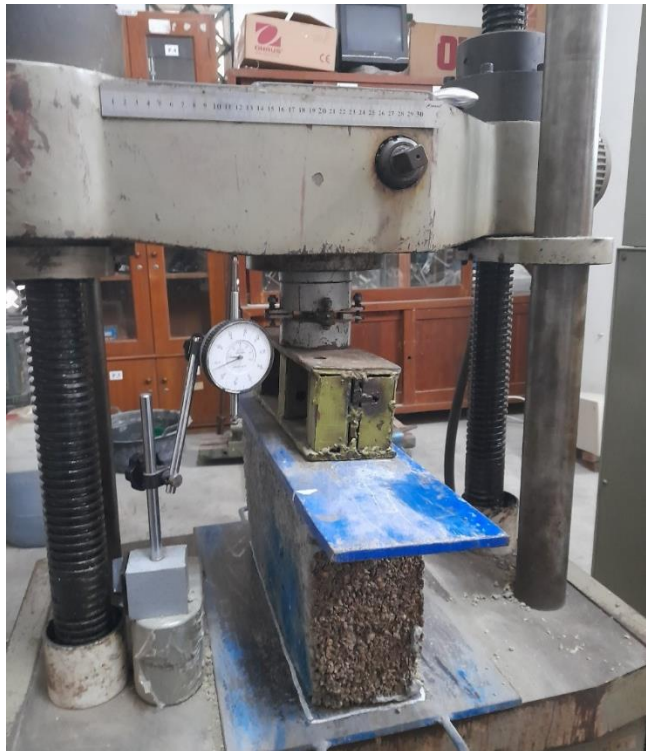
Gambar 4.5 Uji Kuat Tekan dengan Dial Pengukur Penurunan
