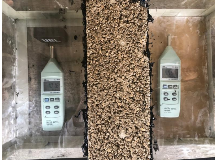
Gambar L-5.1 Pengujian Redaman Suara Batako Bonggol Jagung
