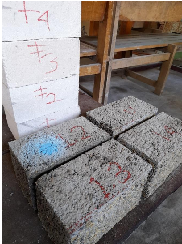
Gambar L-4.3 Hasil Potongan Untuk Uji Penyerapan Air
