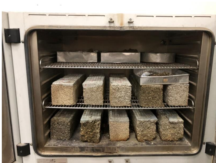
Gambar 4.9 Benda uji dalam oven
