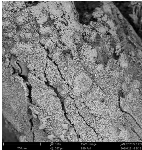
Gambar L-6.9 Pengujian SEM Komposisi Campuran Damdex 0,039% Perbesaraan 350x
