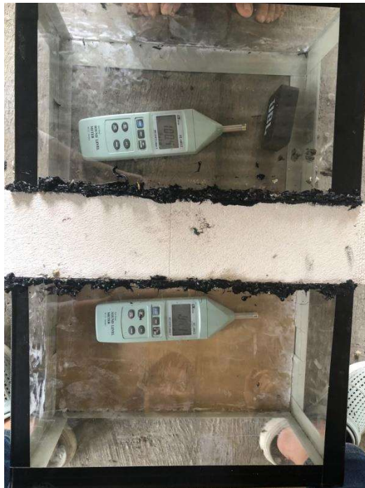
Gambar L-5.2 Pengujian Redaman Suara Bata Ringan Bricon
