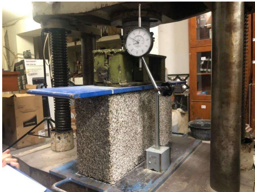
Gambar L-3.4 Pengujian Kuat Desak
