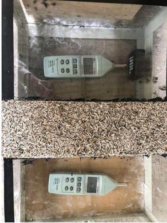
Gambar L-5.1 Pengujian Redaman Suara Batako Sekam Padi
