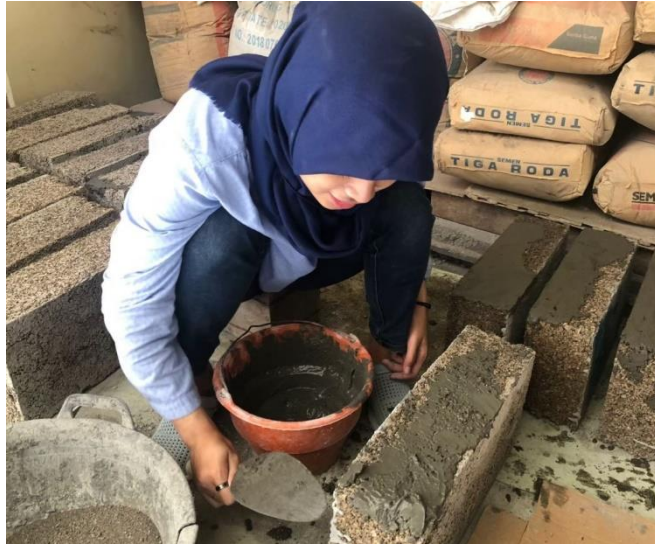
Gambar L-3.1 Perataan Permukaan Benda Uji Sebelum Diuji Tekan
