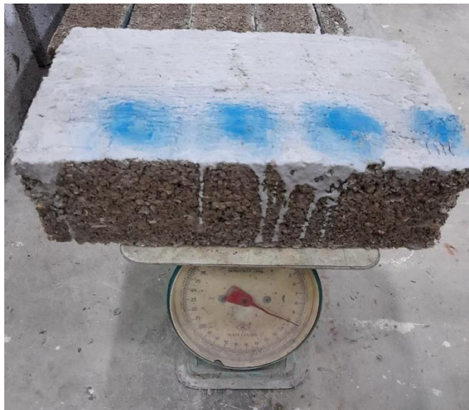
Gambar L-3.2 Penimbangan Benda Uji
