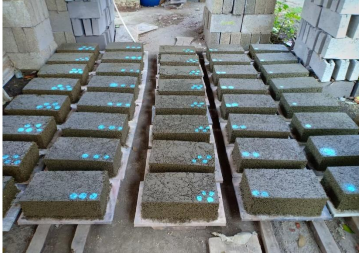
Gambar L-2.1 Benda Uji Setelah Pencetakan
