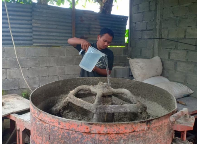
Gambar 4.7 Pencampuran Bahan di dalam Alat Mixer Machine
