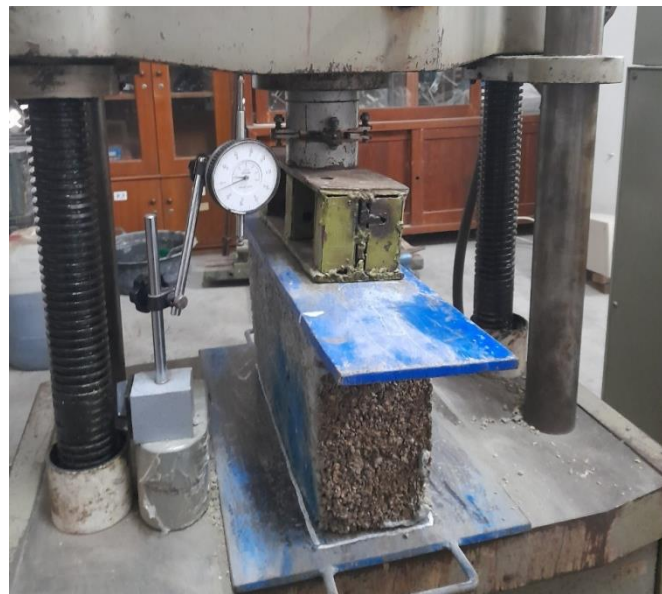
Gambar L-3.4 Pengujian Kuat Desak
