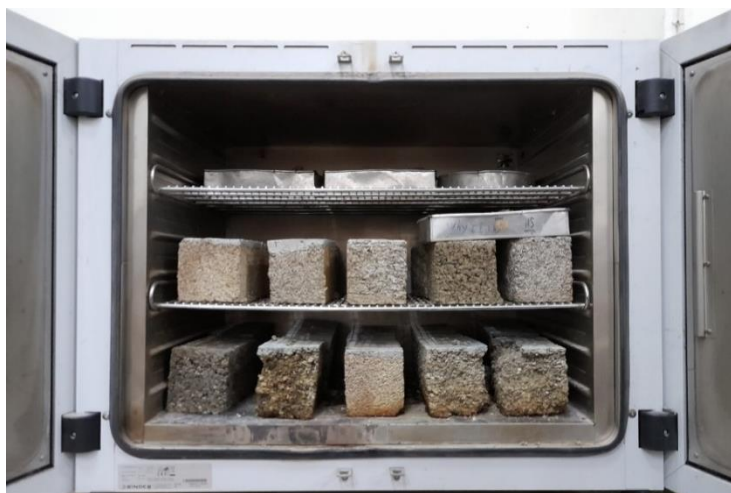
Gambar 4.18 Pengeringan Benda Uji di dalam Oven
