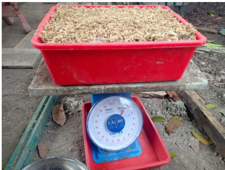
Gambar 4.6 Penimbangan Komposisi Bahan Campuran Batako
