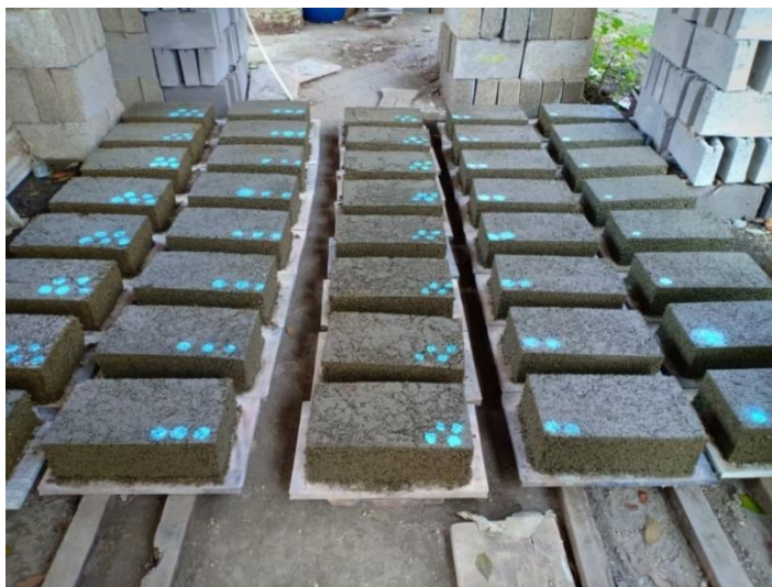
Gambar 4.11 Penataan Batako Setelah Dicitak
