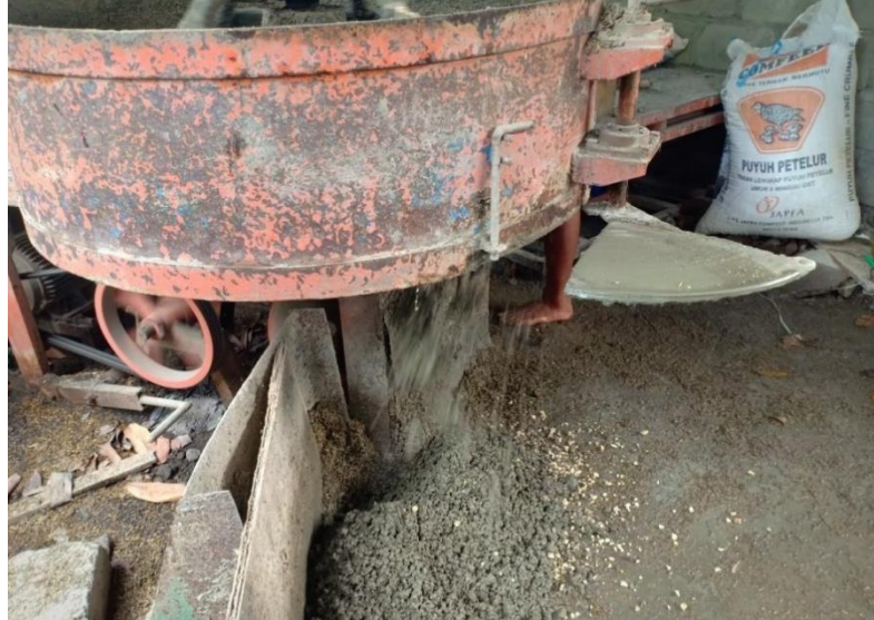
Gambar 4.9 Adonan Batako Segar yang Siap Dicitak
