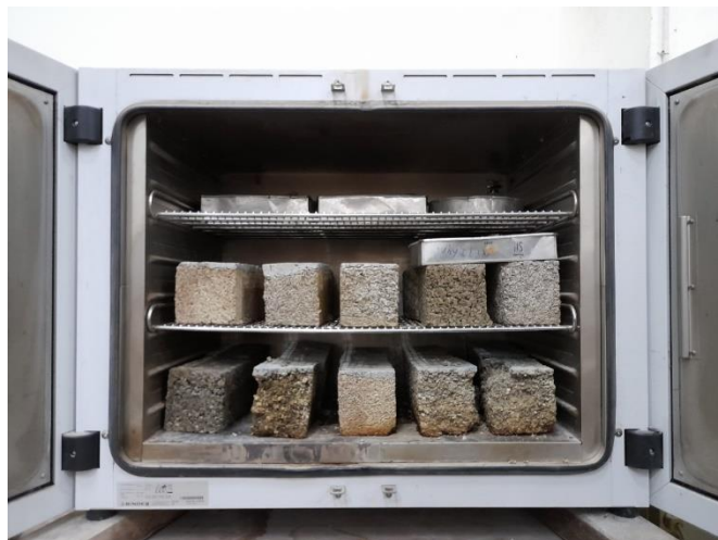
Gambar L-4.5 Benda Uji Dikeringkan di Oven
