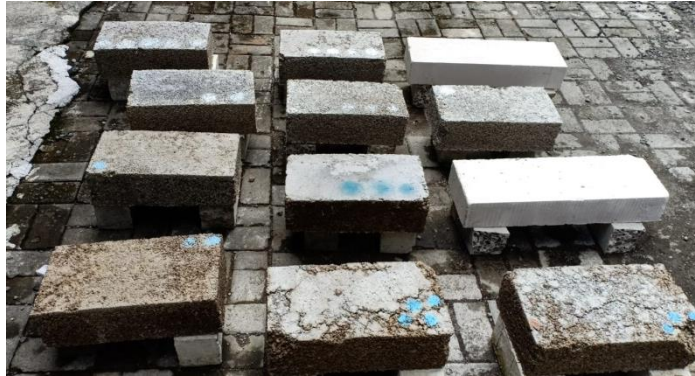
Gambar L-5.1 Penjemuran Benda Uji
