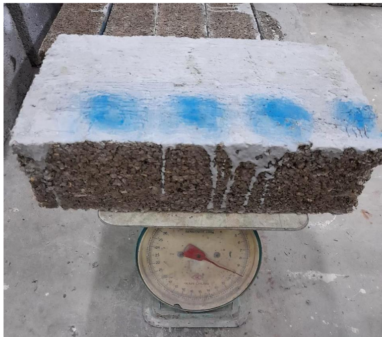
Gambar 4.13 Pengukuran Berat Batako
