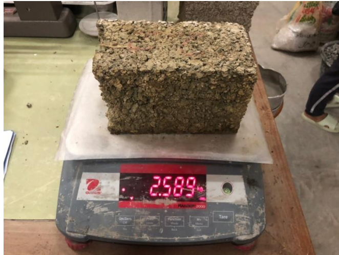
Gambar L-4.6 Penimbangan Benda Uji Setelah Kering
