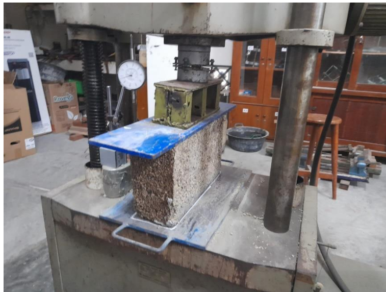
Gambar 4.14 Batako Diletakkan pada Alat Desak
