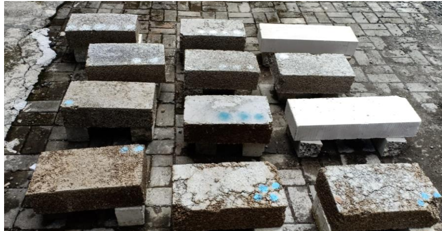
Gambar 4.19 Batako Dijemur di bawah Sinar Matahari
