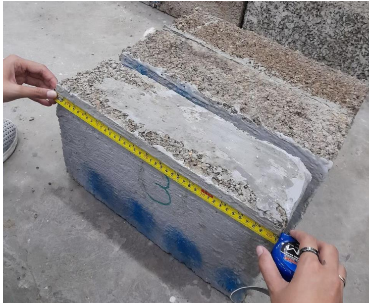
Gambar 4.12 Pengukuran Dimensi Batako
