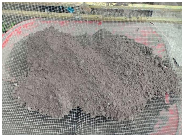
Gambar 3.4 Abu Batu yang Digunakan
