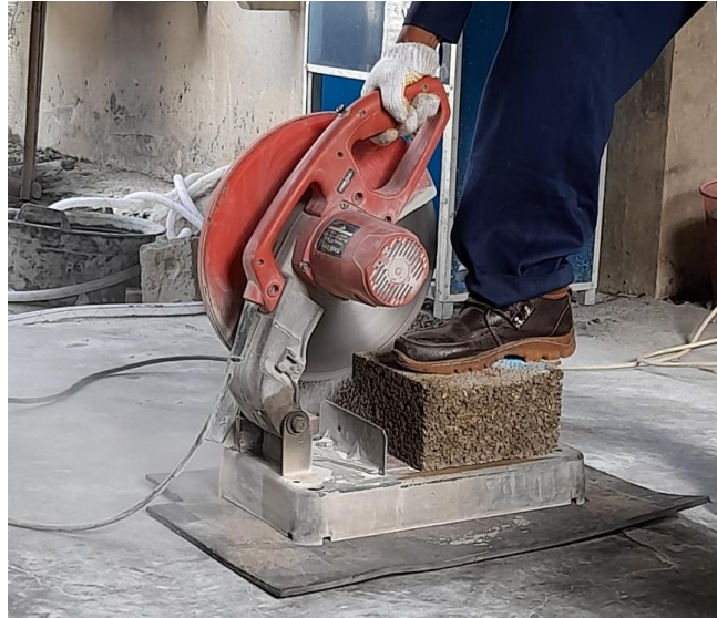
Gambar L-4.1 Pemotongan Benda Uji Menjadi 4 Bagian
