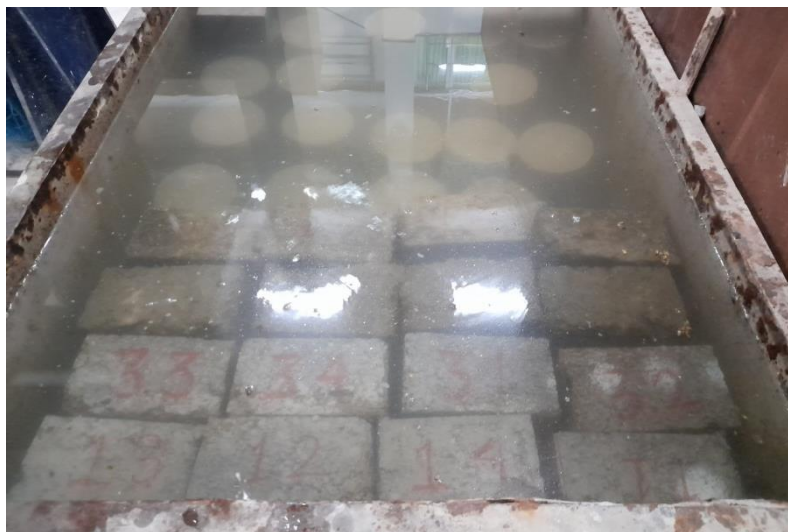
Gambar 4.17 Perendaman Benda Uji
