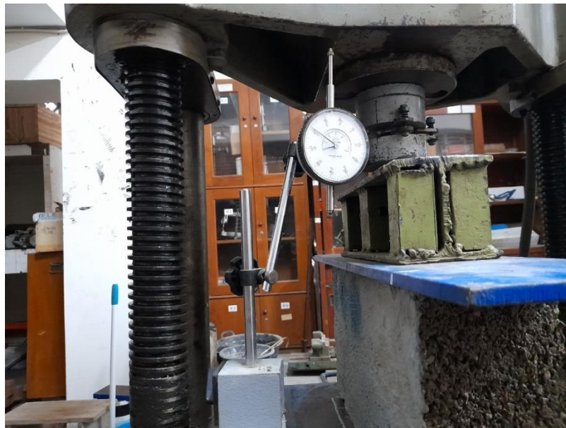
Gambar 4.15 Pemasangan Dial Pengukuran Penurunan
