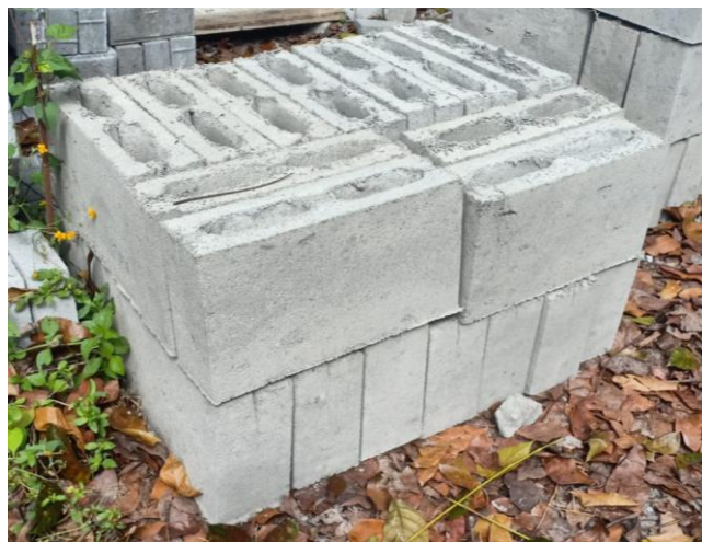
Gambar 3.2 Batako Beton Berlobang
