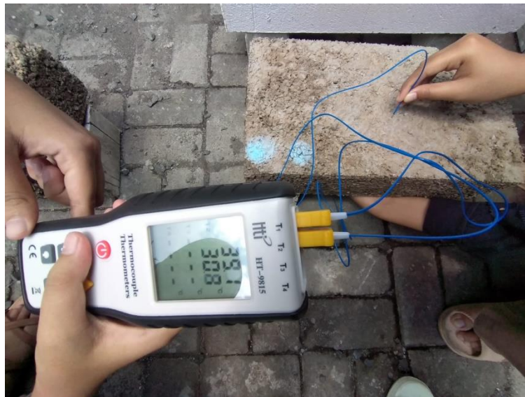
Gambar 4.21 Pengujian Redaman Panas
