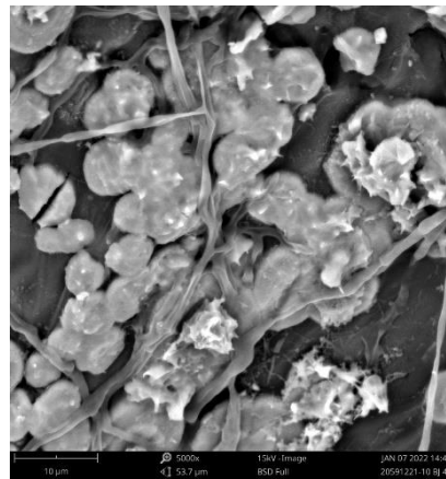
Gambar 5.9 Uji SEM Batako Bonggol Jagung 1 : 1 : 9 5000x
