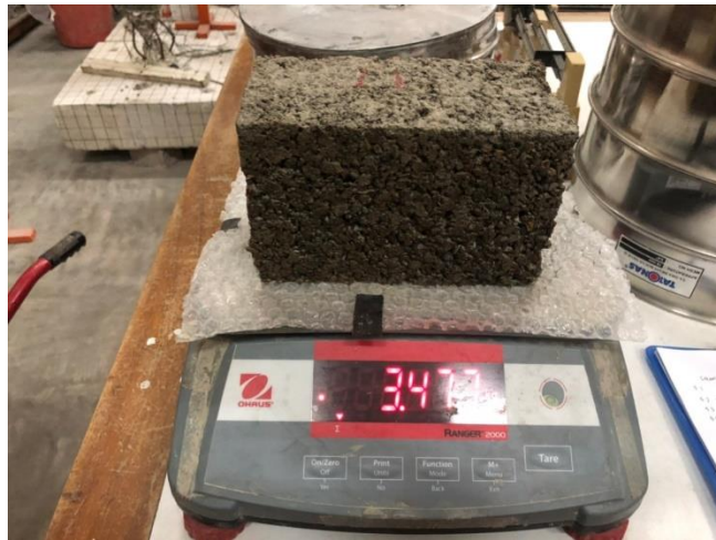
Gambar L-4.4 Penimbangan Benda Uji Setelah Perendaman
