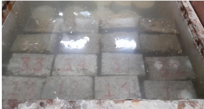
Gambar L-4.3 Perendaman Benda Uji
