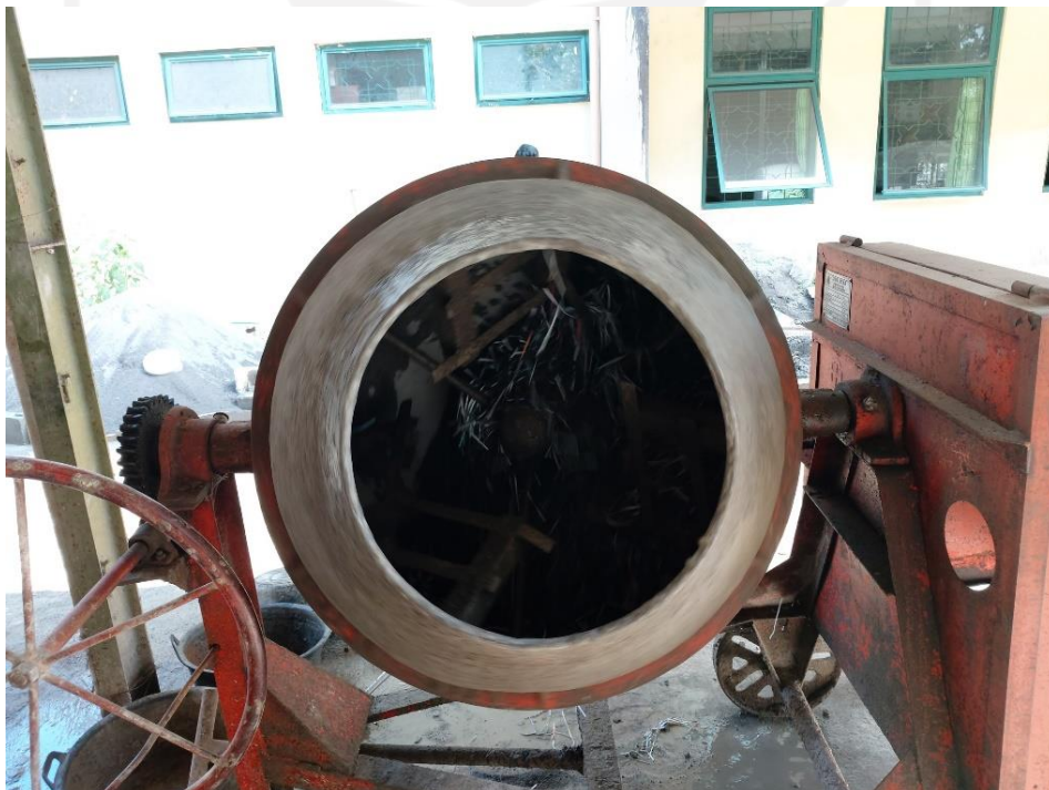
Gambar L-10.8 Proses Pembuatan Campuran Beton
