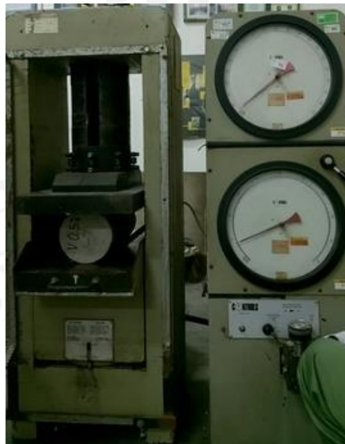
Gambar L-10.16 Pengujian Kuat Tarik Belah Beton
