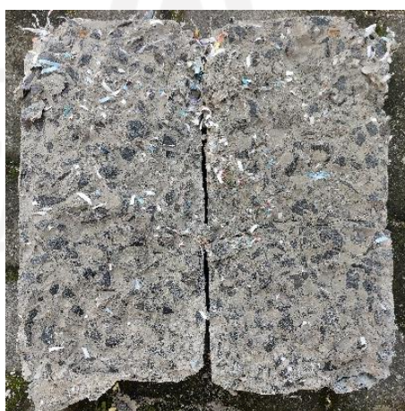
Gambar 5.14 Serat dalam Benda Uji Beton
