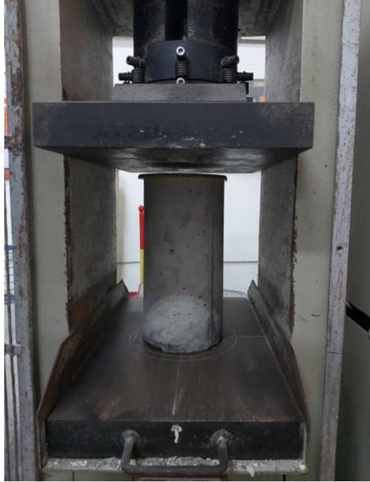
Gambar L-10.15 Pengujian Kuat Tekan Beton
