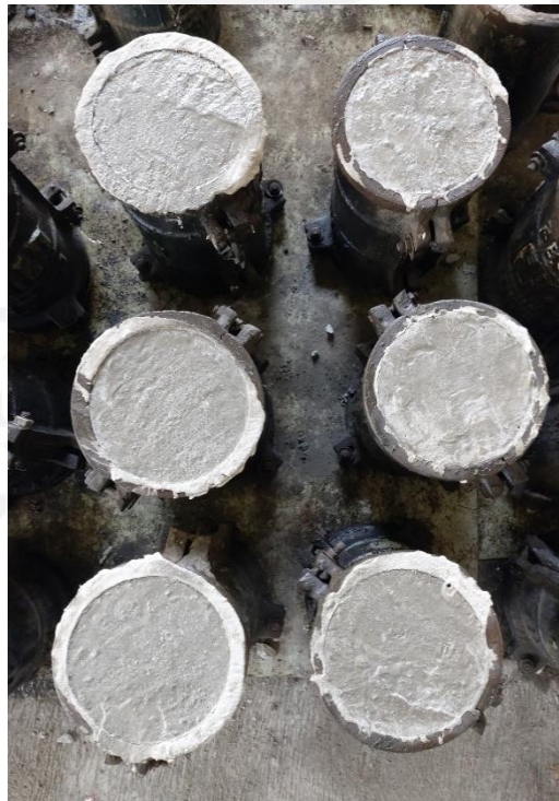
Gambar L-10.10 Benda Uji Beton Umur 1 Hari
