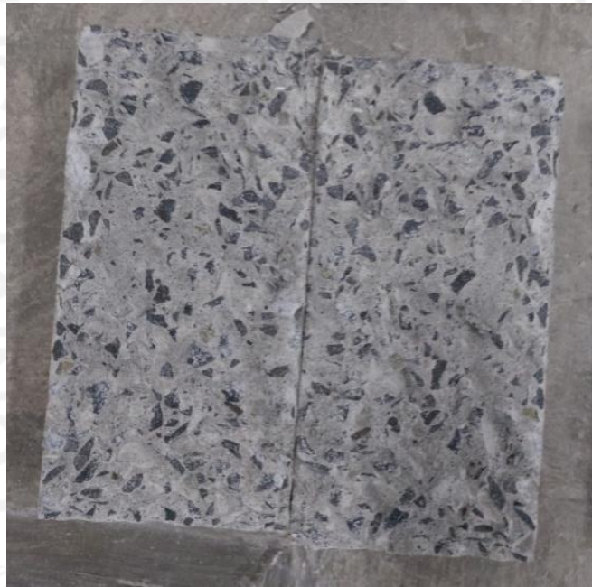
Gambar 5.15 Hasil Uji Kuat Tarik Belah Beton Normal
