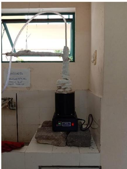
Proses pirolisis tempurung kelapa sawit dengan suhu  $800^{\circ}\text{C}$
