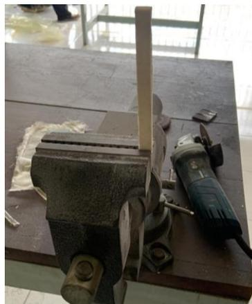
Gambar 3. 28 Pemotongan menggunakan gerinda
