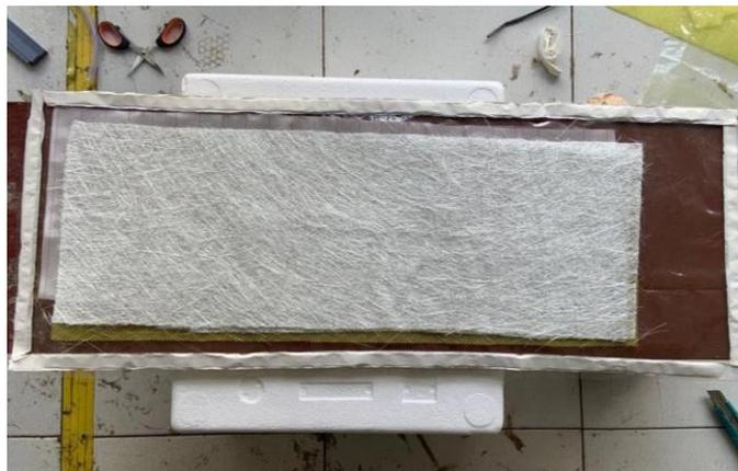
Gambar 3. 22 Lapisan susunan komposit sandwich
