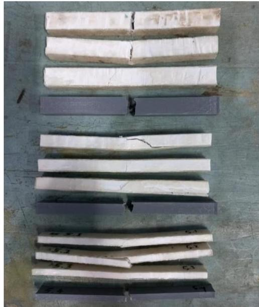
Gambar 4. 2 spesimen uji setelah pengujian *bending*
