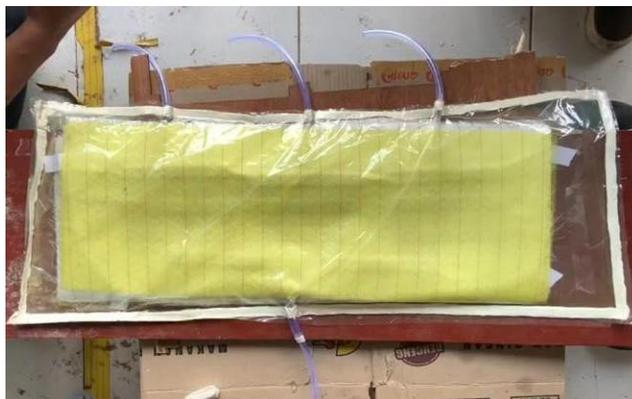
Gambar 3. 24 Memasukkan susunan komposit kedalam plastik
