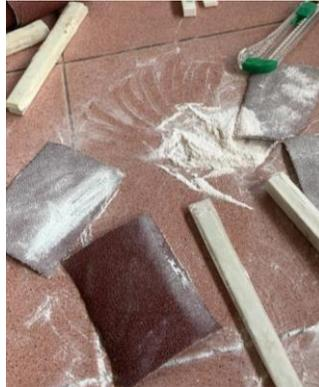
Gambar 3. 29 Proses Pengamplasan spesimen uji
