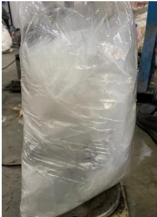
Gambar 7. Sampel plastik yang sudah dibersihkan kemudian dikumpulkan dan dipotong untuk dilakukan pirolisis, total sampel yang digunakan sebanyak 1,5 kg.
