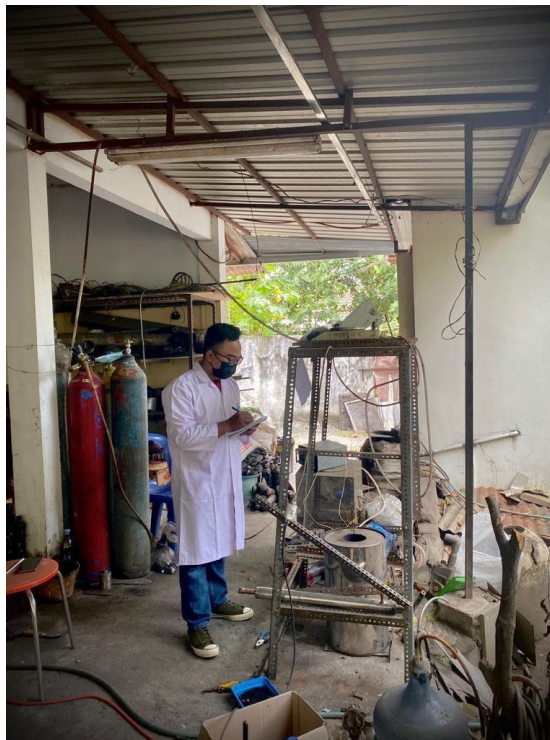
Gambar 23. Ini merupakan pengamatan laju pembakaran yang dilakukan untuk mengetahui selisih dari jumlah penyusutan briket yang sedang diuji,
