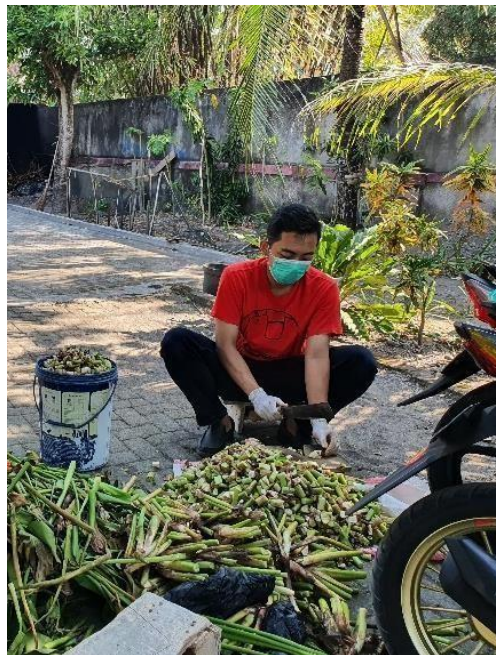
Gambar 11. Eceng gondok dipotong-potong berukuran kurang lebih 3-5 cm kemudian dikumpulkan disatu bagian wadah untuk dilakukan proses penjemuran.
