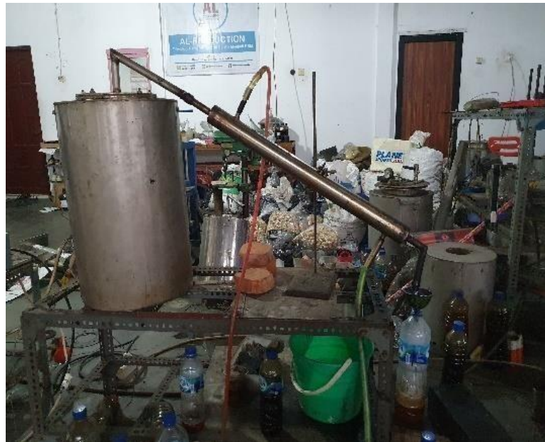
Gambar 15. Sampel eceng gondok dilakukan pirolisis, bahan baku yang digunakan dalam pembuatan briket ini adalah biocar, biocar merupakan sisa dari proses pirolisis yang terdapat pada tabung reaktor.
