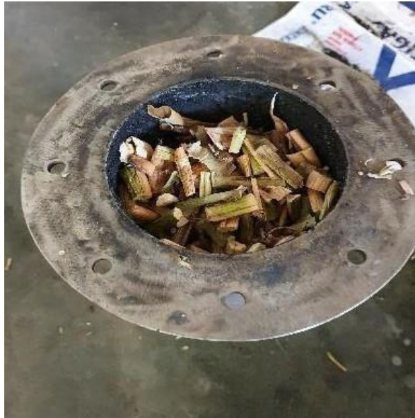
Gambar 14. Sampel eceng gondok kering yang sudah siap untuk dipirolisis, pada saat memasukkan sampel ke tabung reaktor, sampel dipadatkan terlebih dahulu agar kapasitas dapat digunakan secara maksimal
