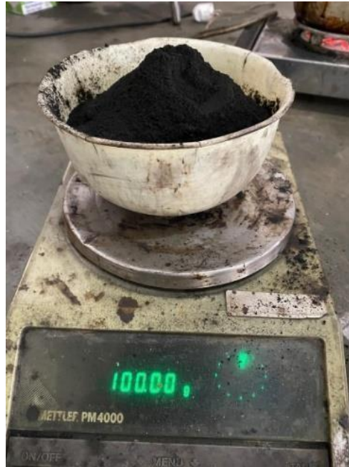
Gambar 18. Ini merupakan biocar yang telah melalui proses pengayakkan berskala 20 mesh. Sampel ini sudah siap untuk digunakan menjadi bahan baku dalam pembuatan briket.
