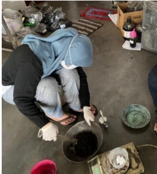
Gambar 20. Proses pencampuran eceng gondok dan tar ldpe, dengan komposisi 100gr Eg + 25ml LDPE, 100gr Eg + 50ml LDPE dan 100gr EG + 75ml LDPE, kemudian untuk seluruh variasi komposisi ditambahkan 10 gr lem kayu.
