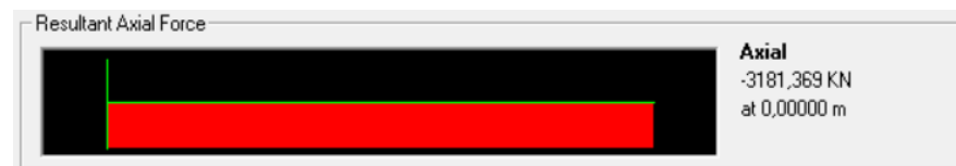
Gambar 5.28 Gaya Aksial Tekan Maksimum Batang Diagonal
