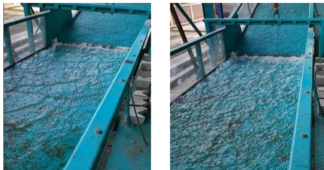
Gambar 5.1. Aliran Tanpa Baffle Blocks pada bukaan 2 dan 3
