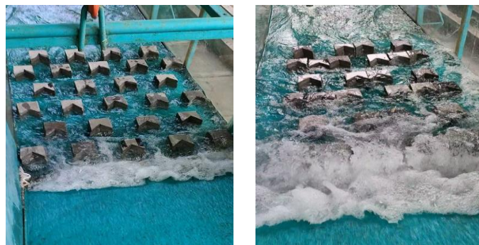
Gambar 5.4. Aliran Dengan Baffle Blocks pada bukaan 2 dan 3
