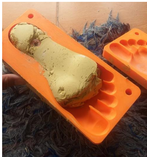
Gambar 4- 46 Defect Pada Proses Pembuatan Telapak Kaki Palsu
