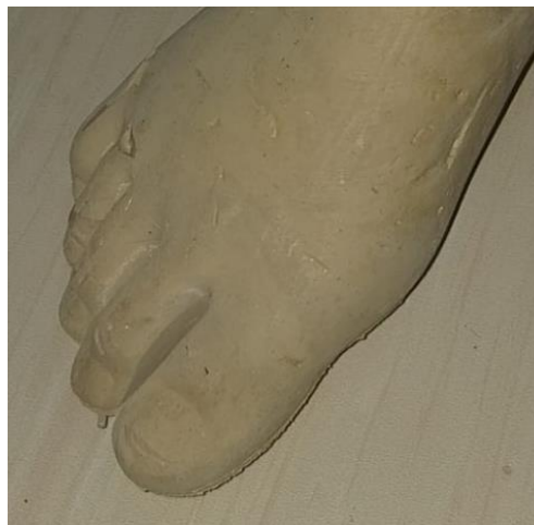
Gambar 4- 47 Defect Pada Telapak Kaki Palsu Produk 2
