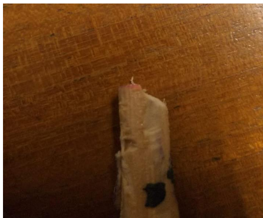
Gambar 4- 50 Spesimen Dari Pengujian Pin On Disc Gagal
