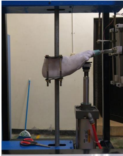
Gambar 4- 28 Proses Pengujian Dorsifleksi Produk Hasil Penelitian 1
