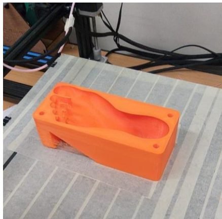
Gambar 4- 3 Hasil 3D Print Cetakan Atas Telapak Kaki Palsu
