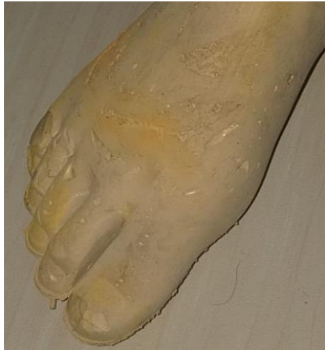
Gambar 4- 48 Defect Pada Telapak Kaki Palsu Produk 3
