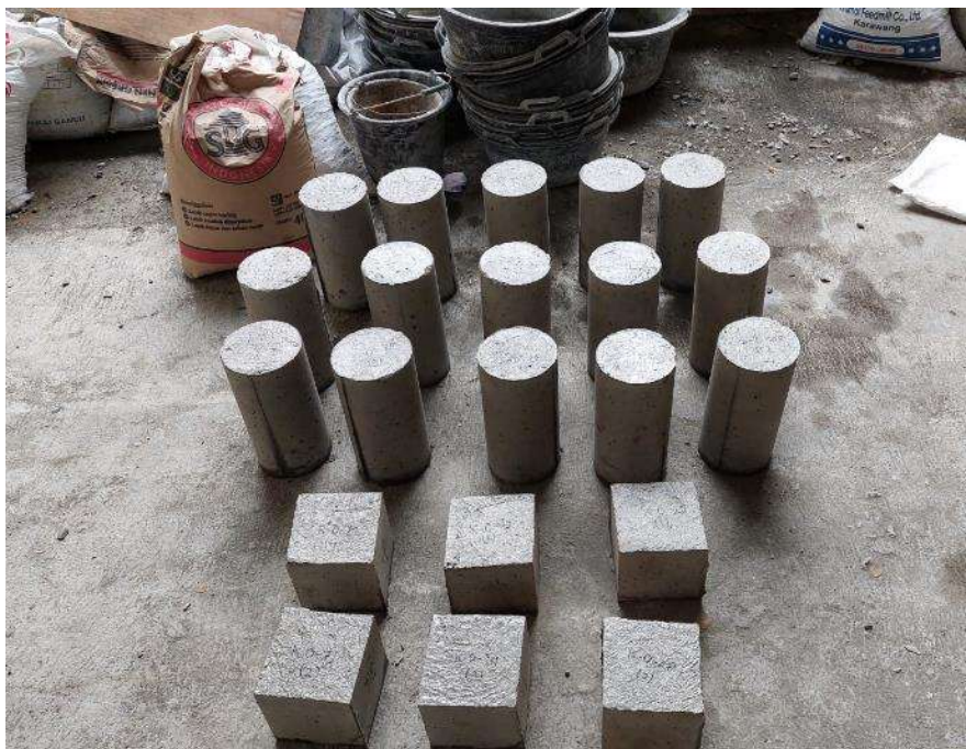
Gambar L-8.3 Benda Uji Beton Normal Sebelum Pengujian
