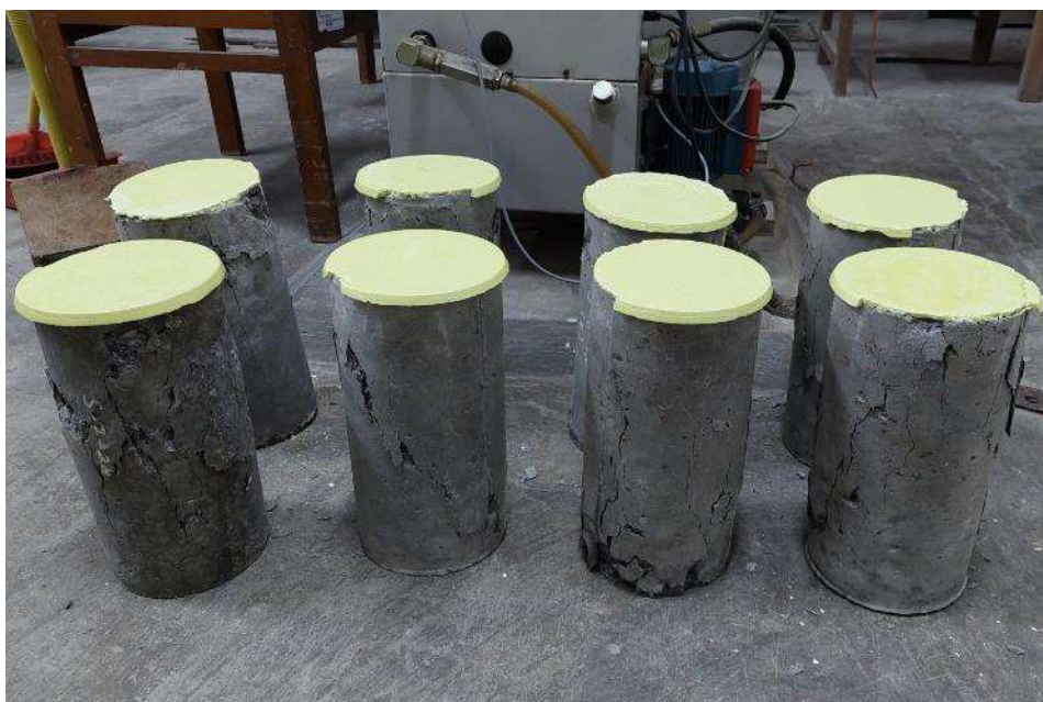
Gambar L-8.5 Benda Uji Beton Damdex Setelah Pengujian
