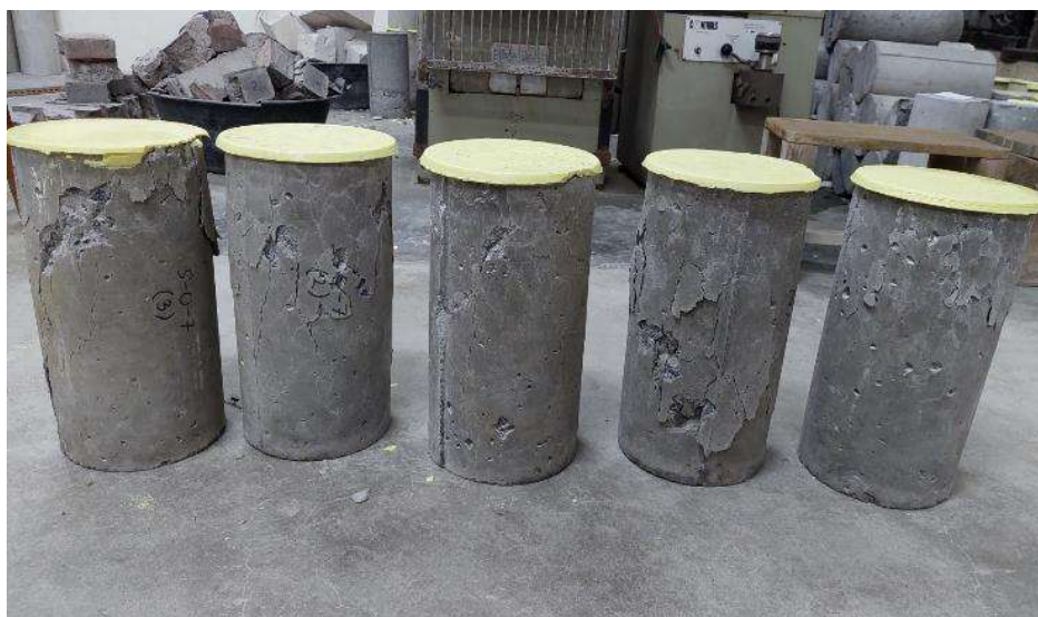
Gambar L-8.4 Benda Uji Beton Normal Setelah Pengujian
