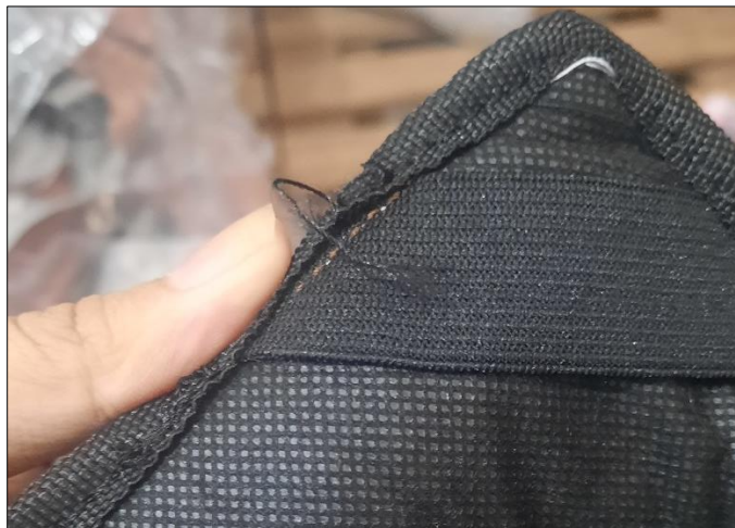
Gambar 5.6 Contoh Cacat Produk Minor Jahitan Tidak Rapi
