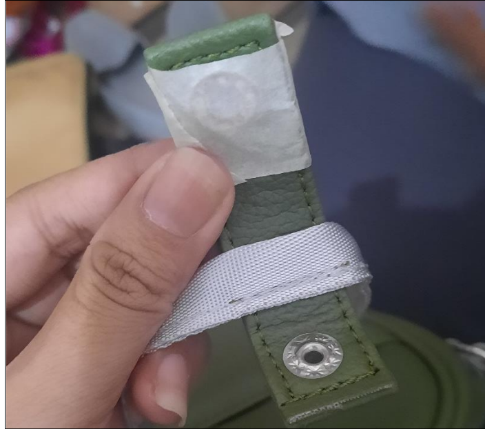
Gambar 5.5 Contoh Cacat Produk Minor Kancing Lepas
