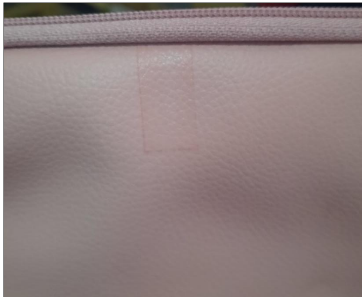
Gambar 5.10 Contoh Cacat Produk Mayor Reject Bahan
