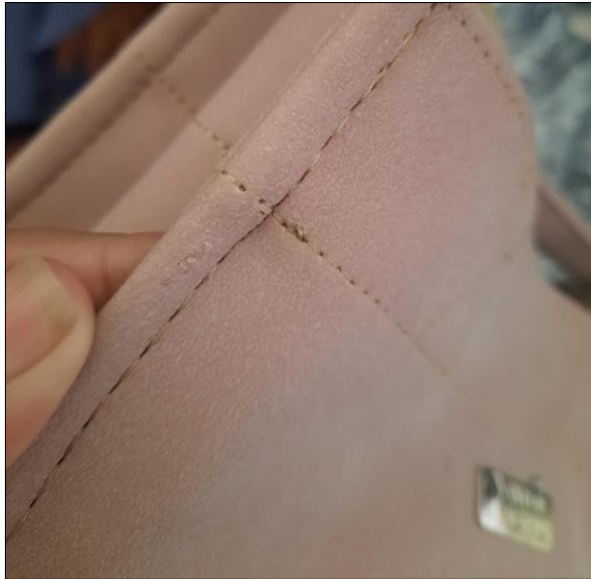
Gambar 5.13 Contoh Cacat Produk Mayor Bekas Sepatu Mesin Jahit
