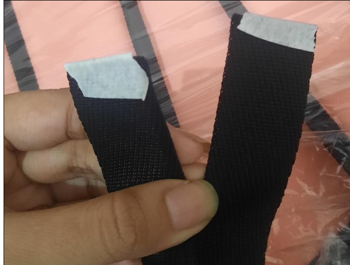
Gambar 5.7 Contoh Cacat Produk Minor Jahitan Terlewat
