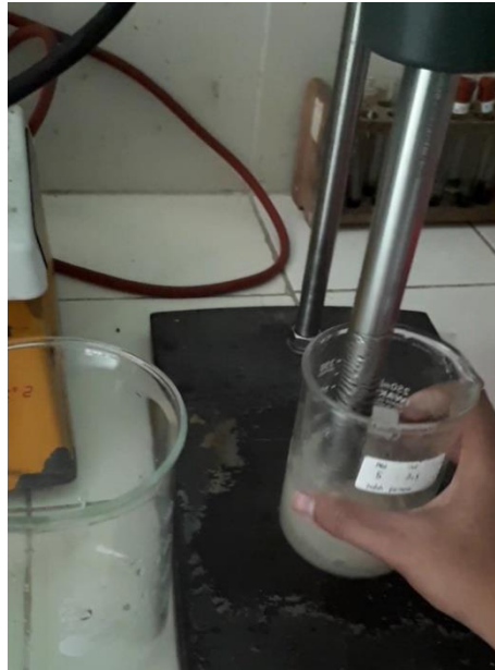
Gambar 12. Proses Homogenisasi Bahan Penyalut Dengan Minyak Atsiri Daun Jeruk Nipis dengan Ultra Turrax merk IKA T18 Basic
