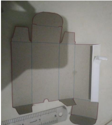
Gambar 4. 44 Penekukan pada tiap garis pola kardus
