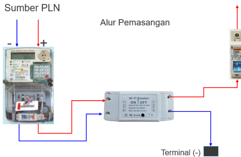
Gambar 4. 39 Alur perancangan pada instalasi listrik
