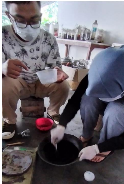
Gambar 6. Pencampuran Arang Eceng Gondok Bubuk, Tar Polypropylene, dan Bahan Perekat
