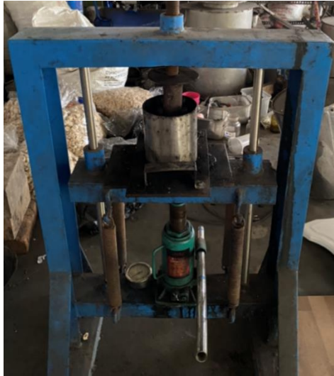
Gambar 8. Pengempaan Briket dengan Menggunakan Alat Kempa Hidrolik
