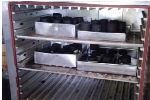
Gambar 9. Pengeringan Briket didalam Oven
