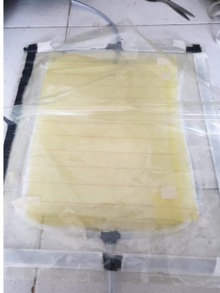
Gambar 3. 20 Memasukkan Bahan Kedalam Plastik Vakum
