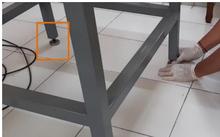
Gambar 4-20 Proses Mengatur Ketinggian Meja Perakitan
