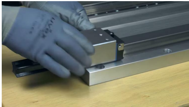
Gambar 4-8 Pemasangan HWIN Block Rails pada LG Sumber: BOSCH Linear Guideway Assembly
