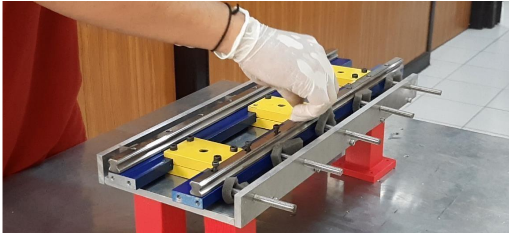
Gambar 4-6 Proses Perakitan Sumbu X
