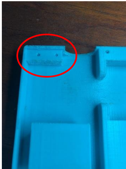
Gambar 4. 8 Kegagalan Hasil Print Kotak MCB Pertama
