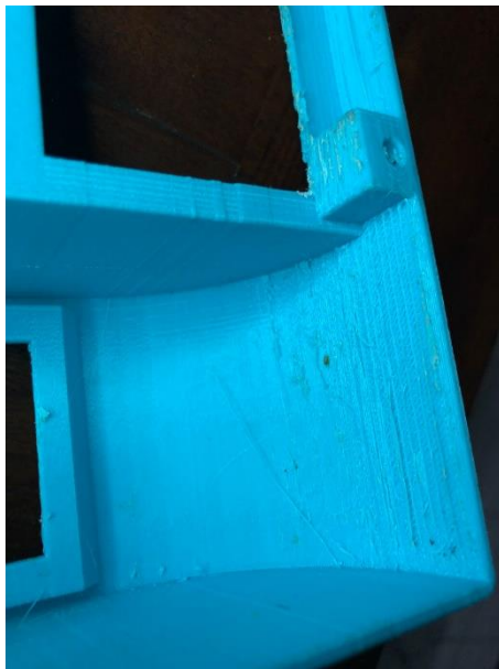
Gambar 4. 11 Kegagalan Hasil Print Tutup Kotak MCB Pertama
