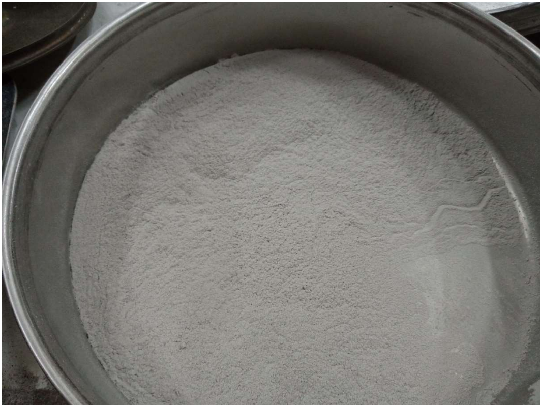
Gambar L-3.1 Abu Sekam Padi Lolos Saringan No.200
