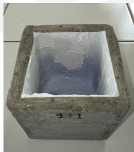
Gambar 21. Keadaan bak semen/TiO 2 setelah proses degradasi larutan MB
