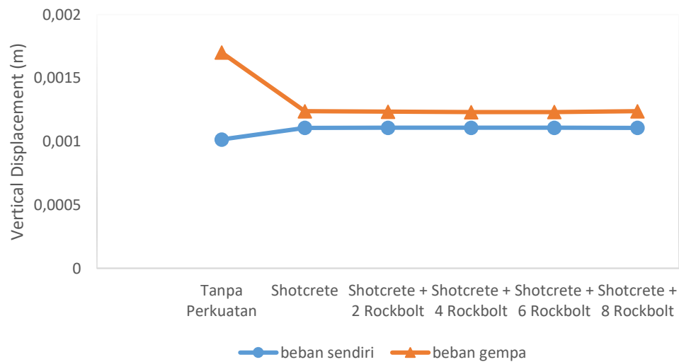
Gambar 5.72 Garfik Nilai vertical Displacement Pada Beban Sendiri dan Beban Gempa
