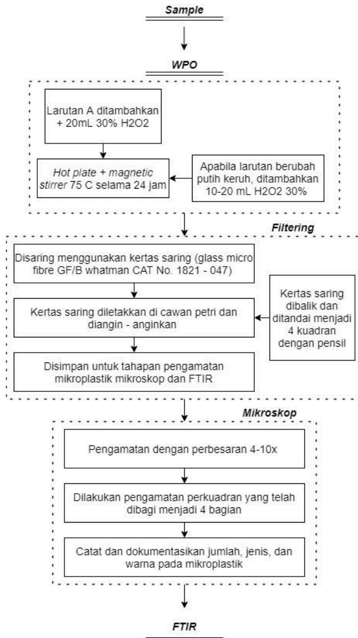
Gambar 3. 15. Diagram Alir Metode Kerja Analisis Sampel Uji (2)
